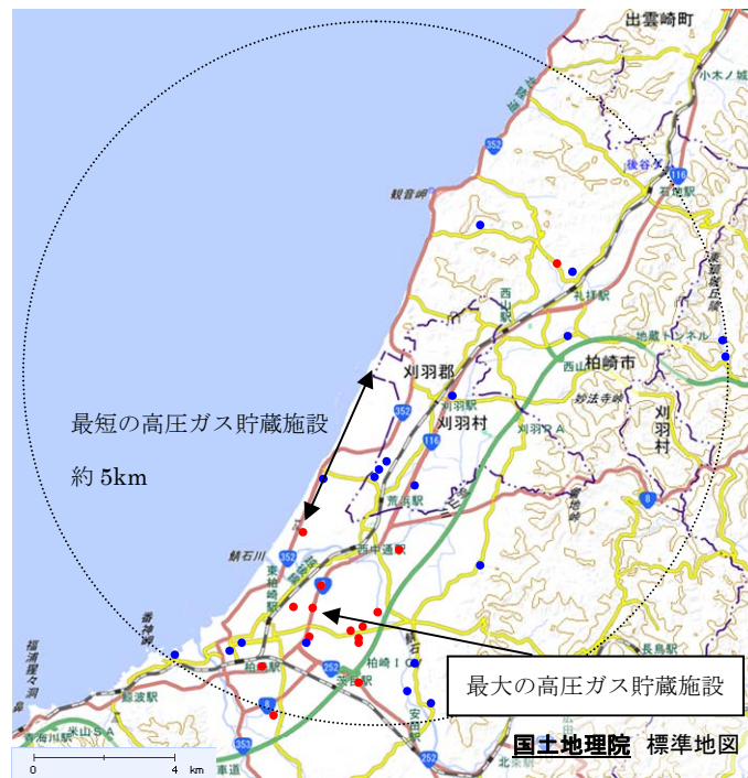
第 3. 2-1 図 最大貯蔵量の高圧ガス貯蔵施設と最短距離の高圧ガス貯蔵施設
