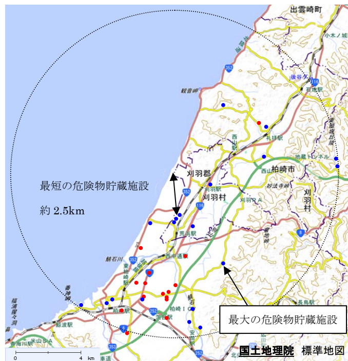
第 3. 1-1 図 最大貯蔵量の危険物貯蔵施設と最短距離の危険物貯蔵施設
