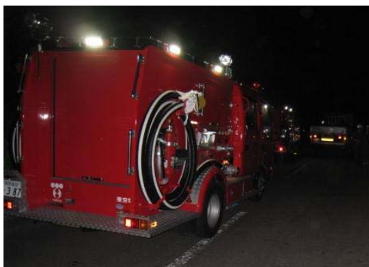
車両の作業用照明
