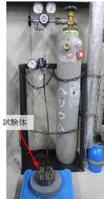
図5 He気密確認試験状況
