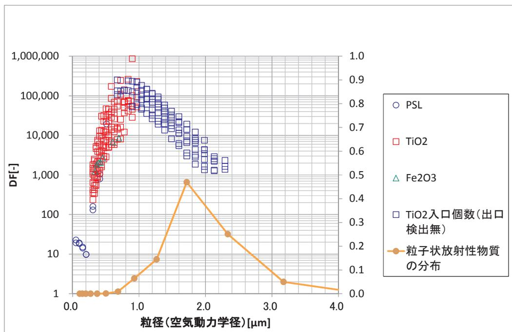
第1-3図 除去性能試験結果 (流量 : 37,000m<sup>3</sup>/h)
