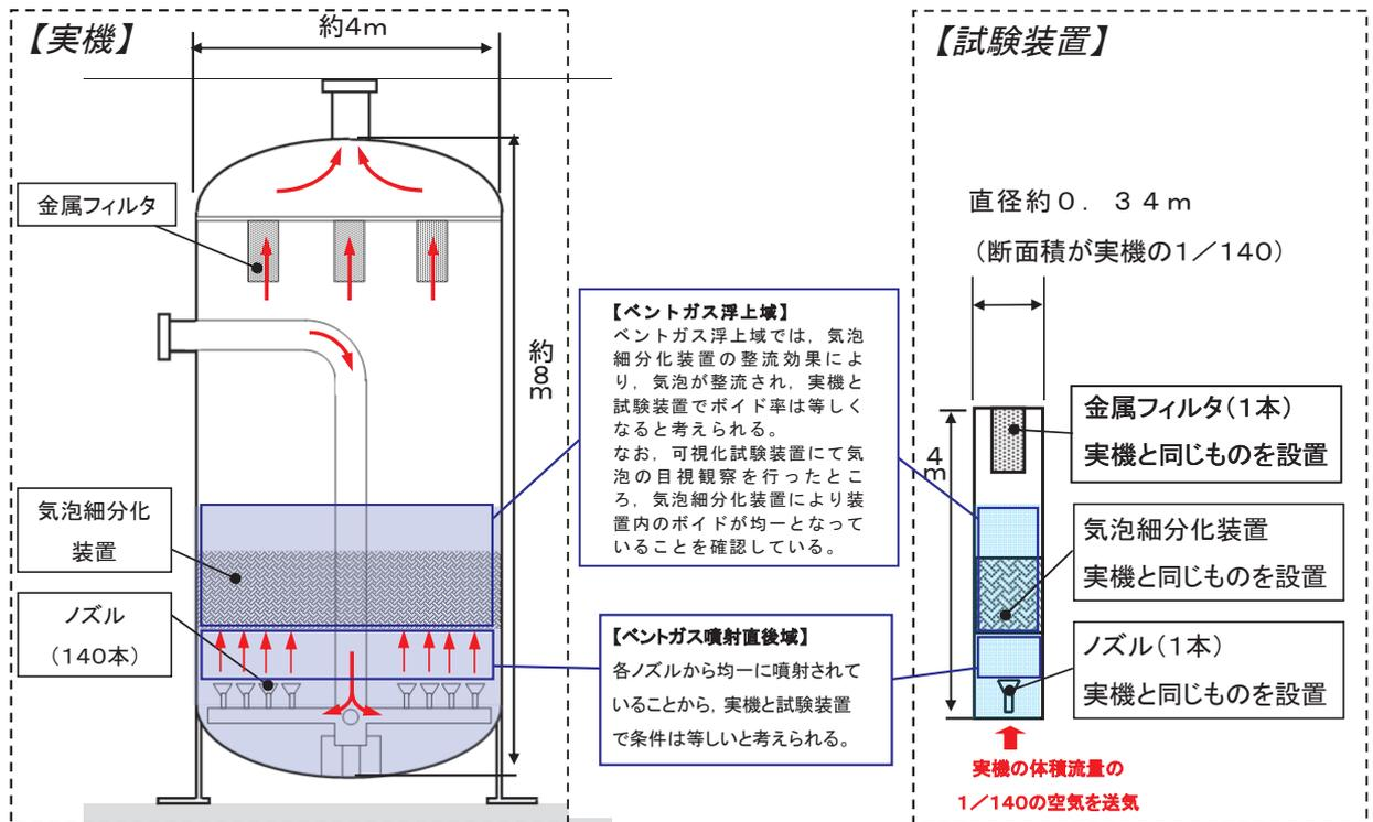
第3-3図 実機と試験装置の比較
