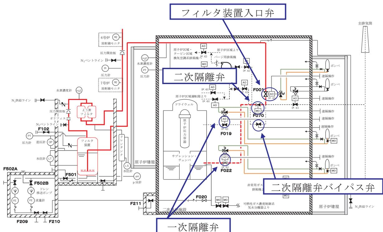
第 1.2.2-1 図 格納容器圧力逃がし装置系統概要
