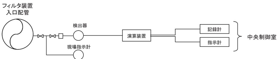
第1-2図 フィルタ装置入口圧力計の概略構成図
