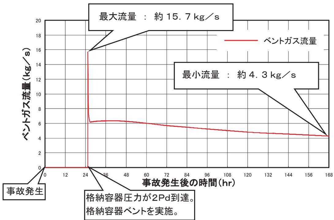
第1-2図 ベントガス流量評価結果
