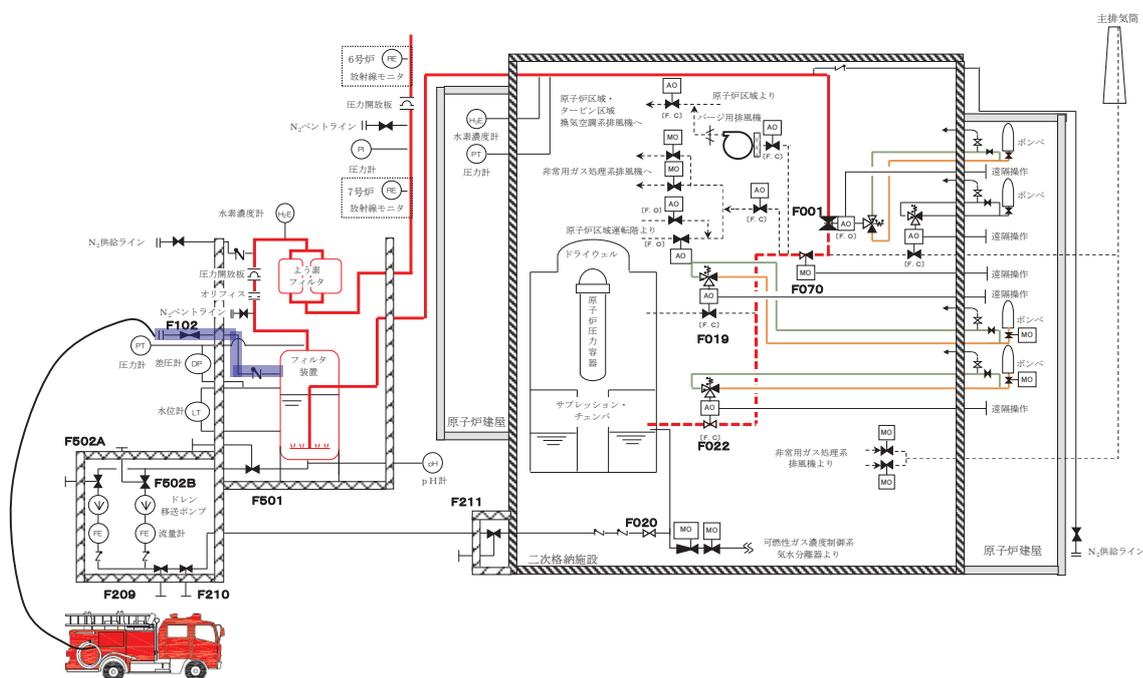
第 2.3.3.2-1 図 格納容器圧力逃がし装置 給水設備系統図
