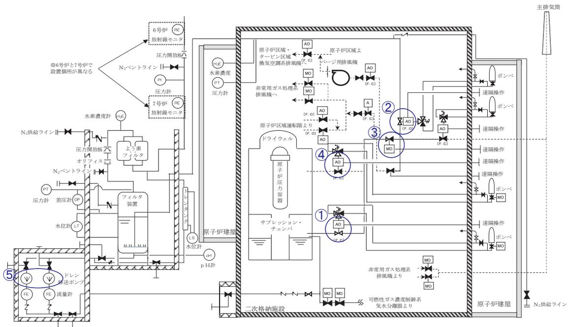
第2.3.1.2-1図 格納容器圧力逃がし装置概略図
