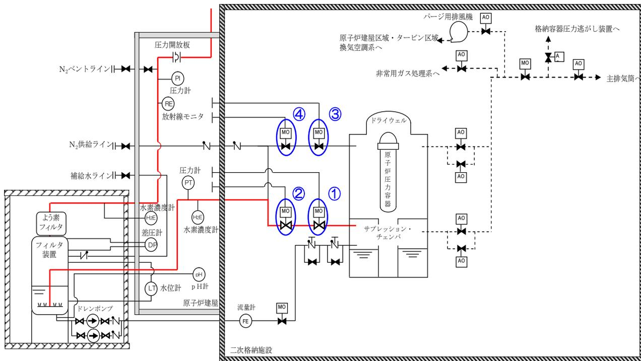
第 4. 1. 2-4 図 代替格納容器圧力逃がし装置操作概略図
