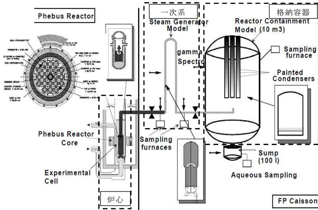
第 3.2.2.1-12 図 試験装置の概要
