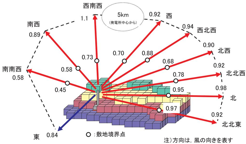
希ガス実効線量の影響(主排気筒/FV)
