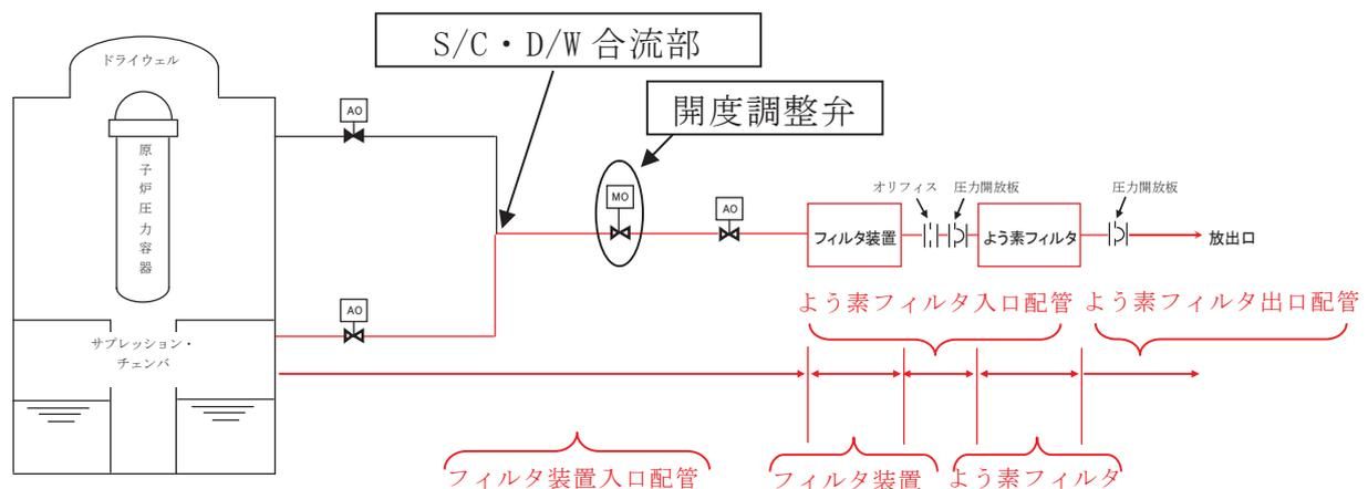
第 1.1-1 図 格納容器圧力逃がし装置 主ライン概略構成図
