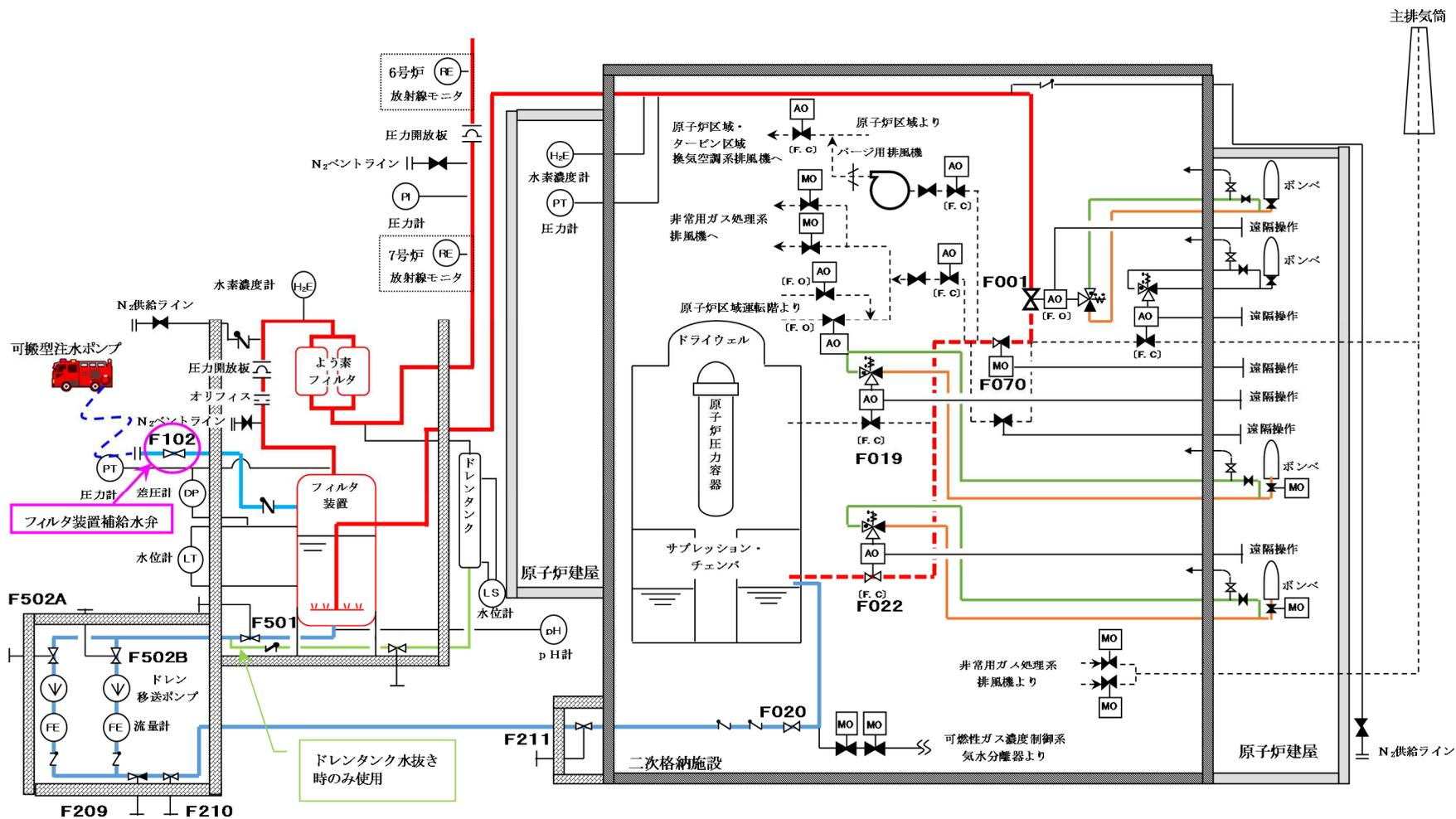
4.1.2-3 図 フィルタ装置水位調整操作概略図
