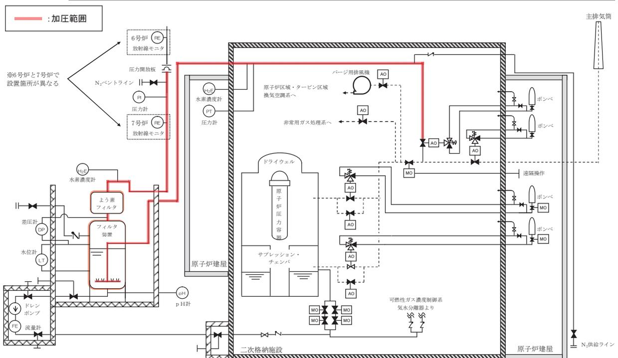
第 5.2-3 図 漏えい試験概要図
