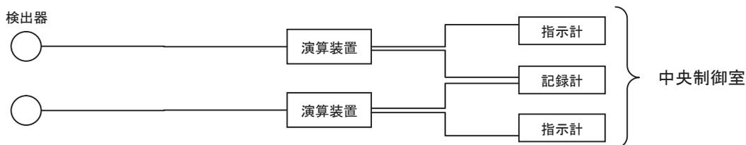
第1-1図 フィルタ装置水位計の概略構成図
