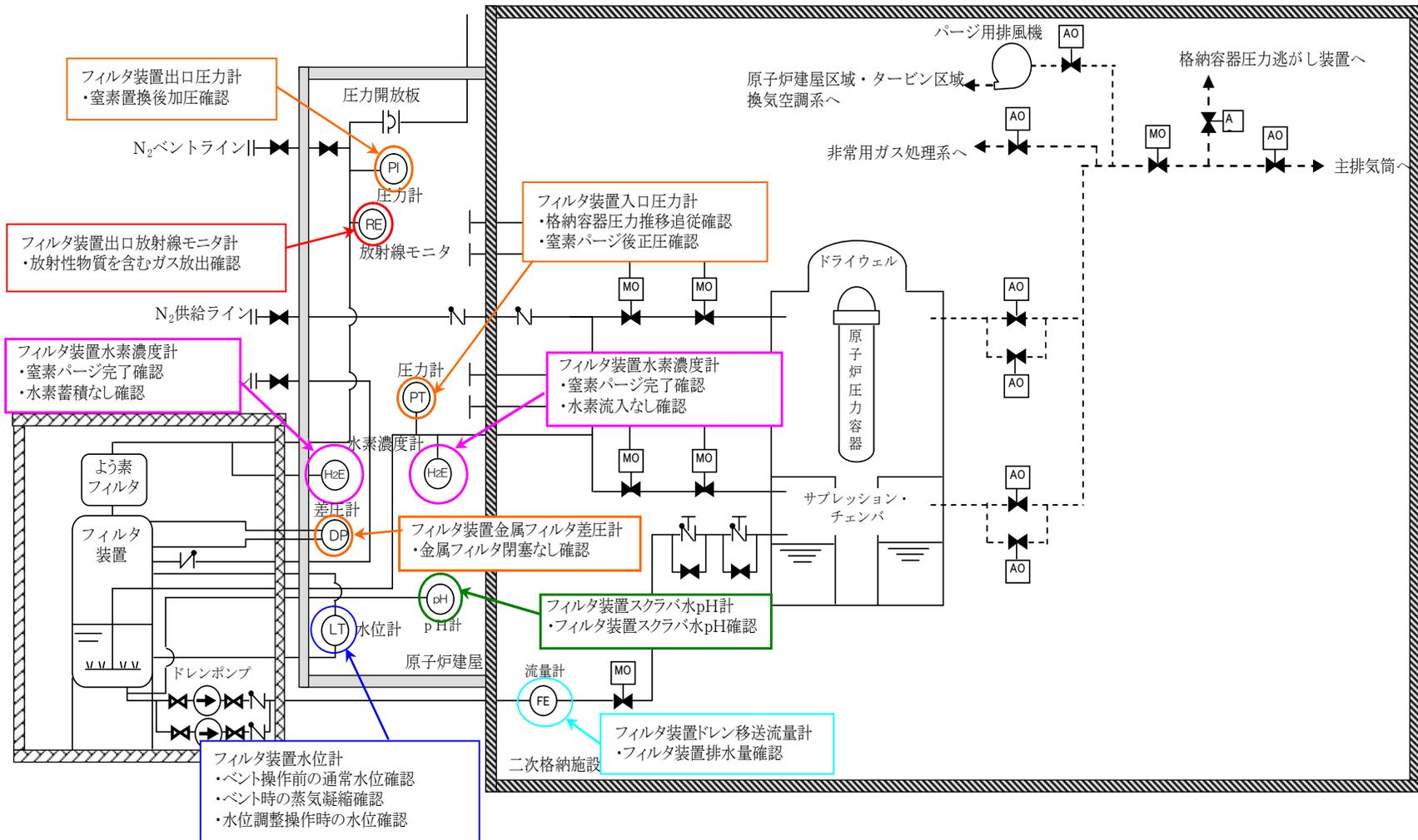
第 4.1.3-2 図 代替格納容器圧力逃がし装置監視計器概要図
