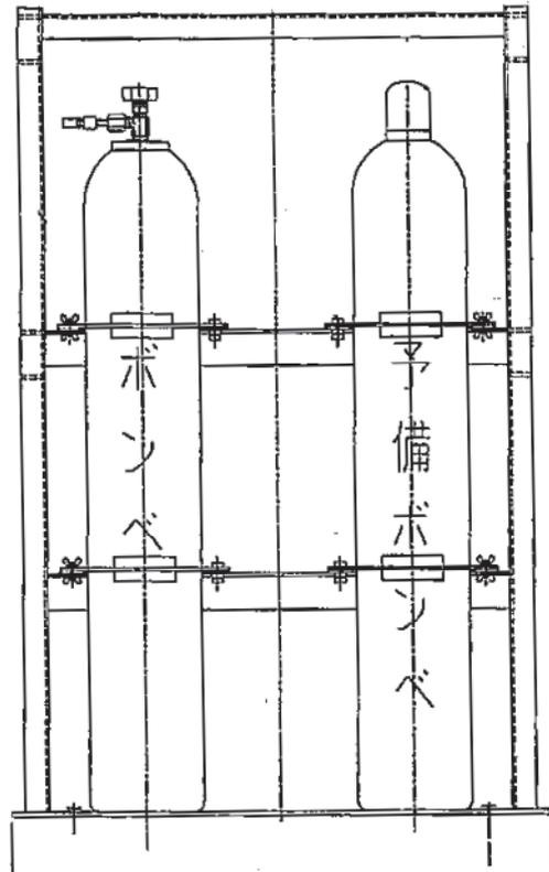
第8図 AO弁駆動ポンベラック構造図
