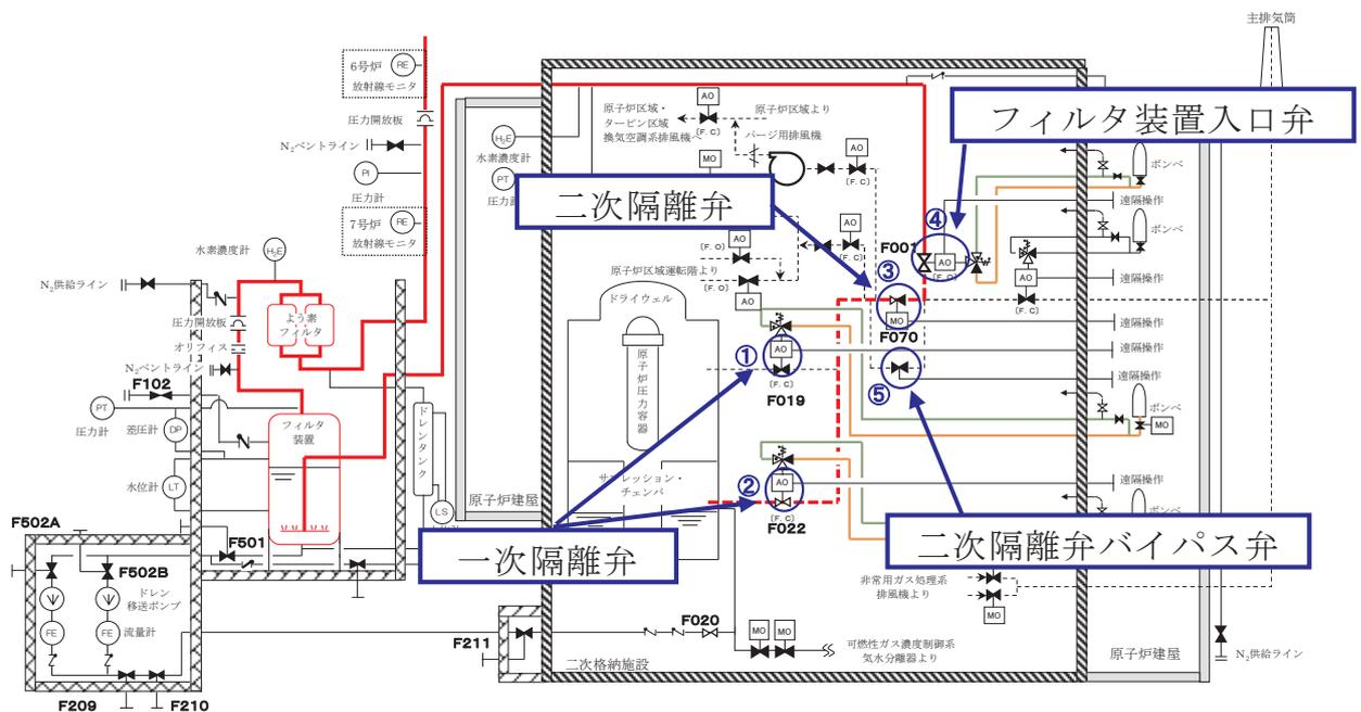
第 1 図 格納容器圧力逃がし装置系統概要と主要弁
