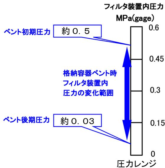
第 3.2.2.2-5 図 フィルタ装置内圧力の評価結果
