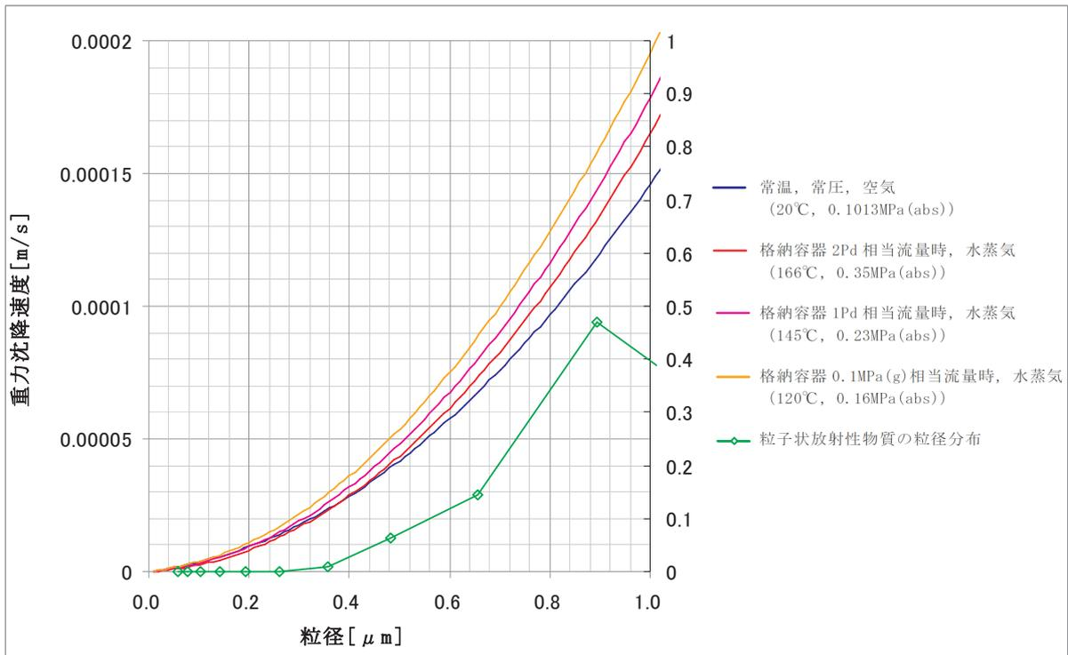
第 4-3 図 粒径と重力沈降速度
