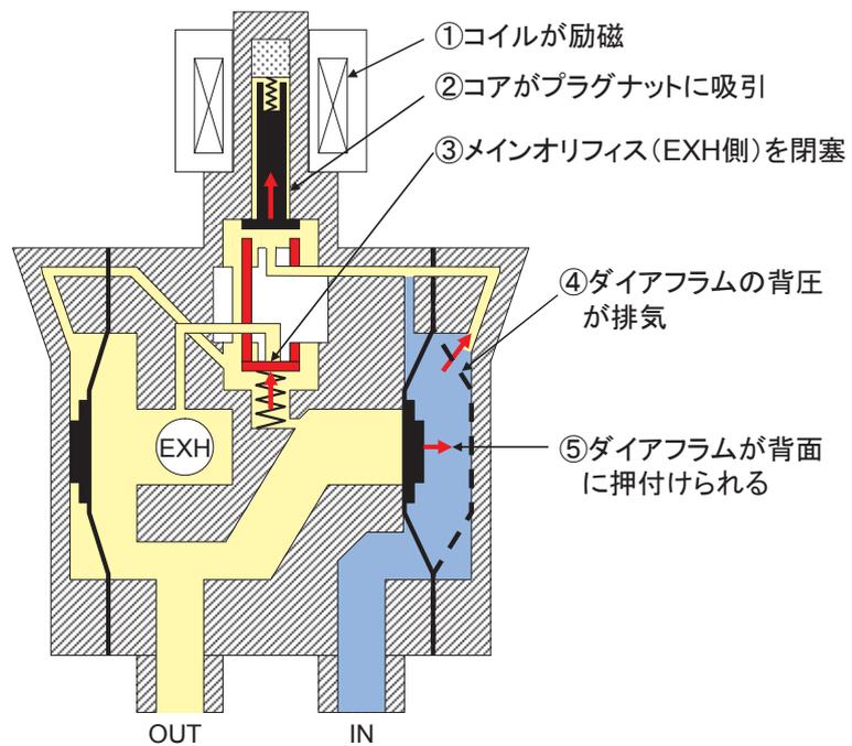
第5図 励磁時直後の動作概要図
