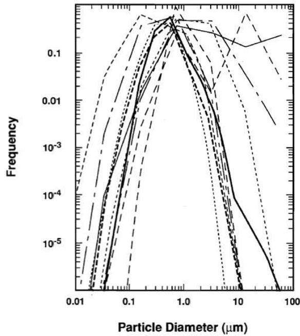
第 3.2.2.1-10 図 STCP (Source Term Code Package) によるシビアアクシデント時における格納容器内エアロゾル粒径分布の評価例
