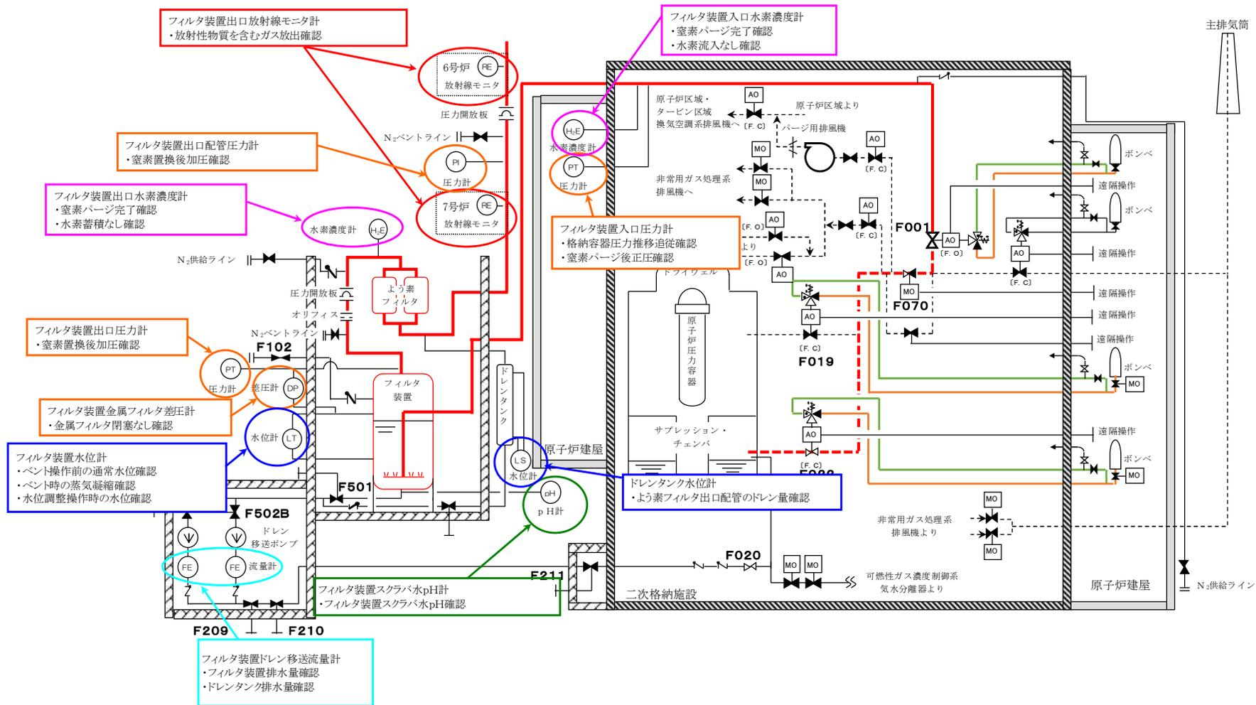
第 4.1.3-1 図 格納容器圧力逃がし装置監視計器概要図
