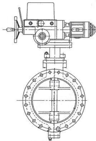
第 2.2.2.2-2 図 電動駆動弁
