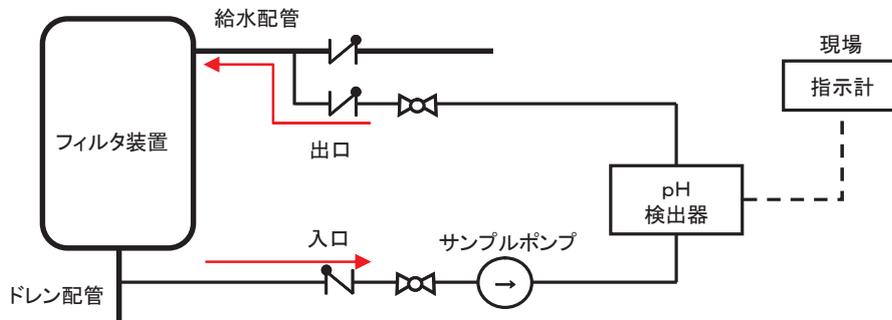
第1-8図 フィルタ装置スクラバ水 pH 計 システム概要図
