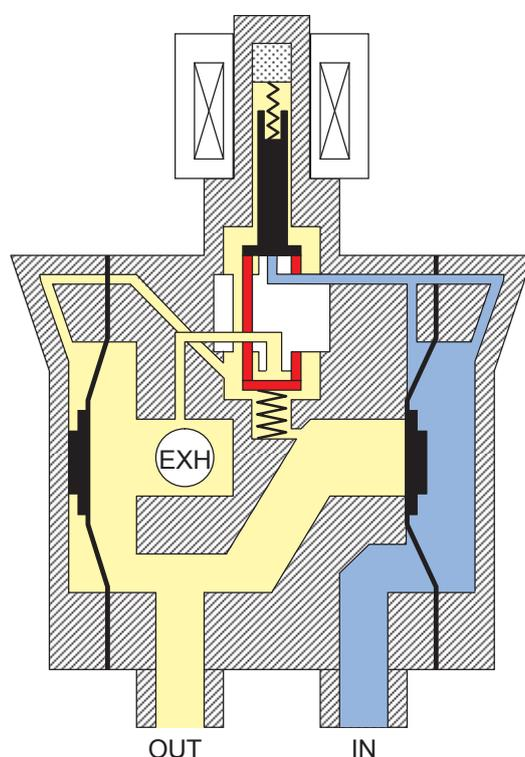
第4図 電磁弁（待機時）の概要図
