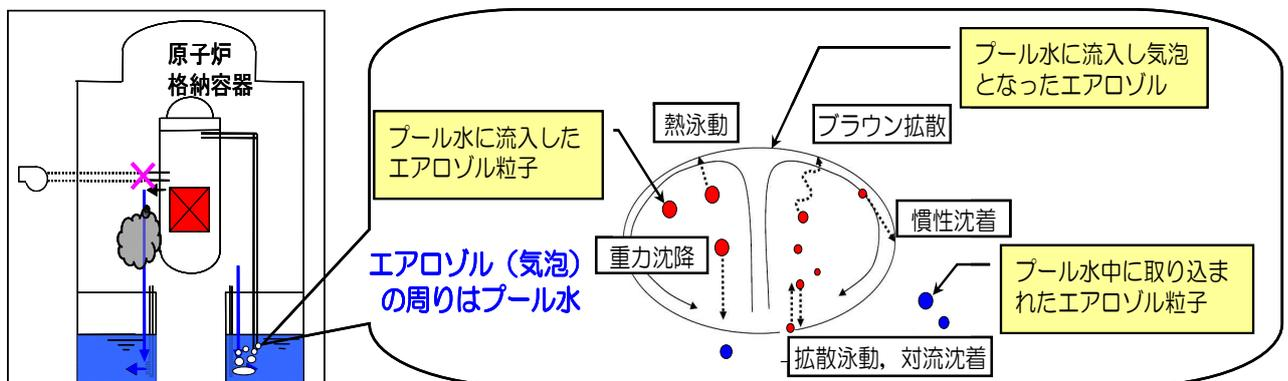
第 3.2.2.1-4 図 粒子径分布の評価モデル
