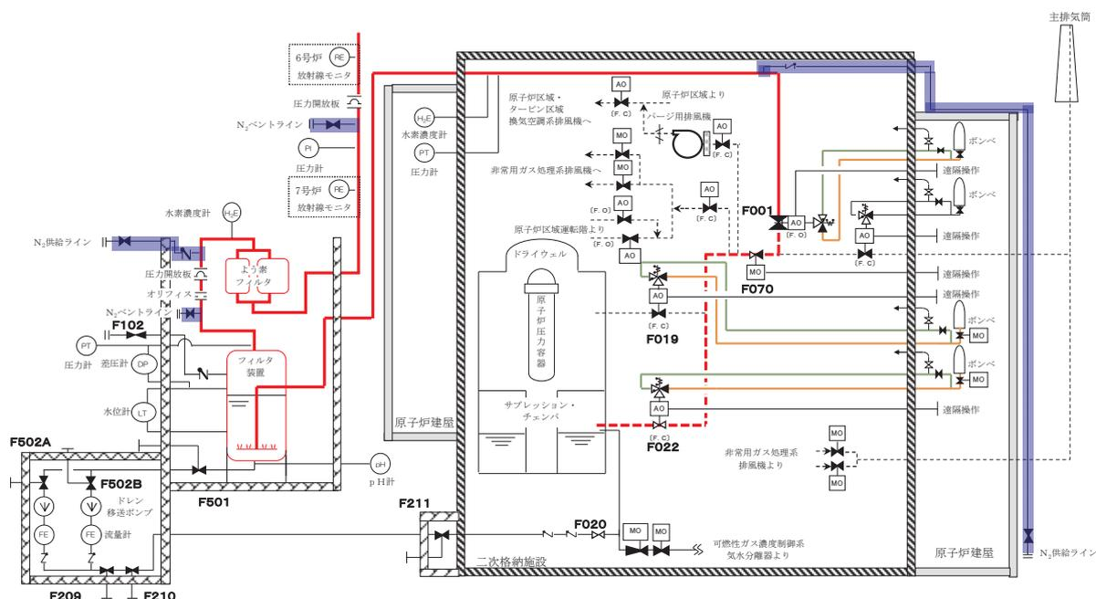
第 2.3.5.2-1 図 格納容器圧力逃がし装置 窒素パージ設備系統図
