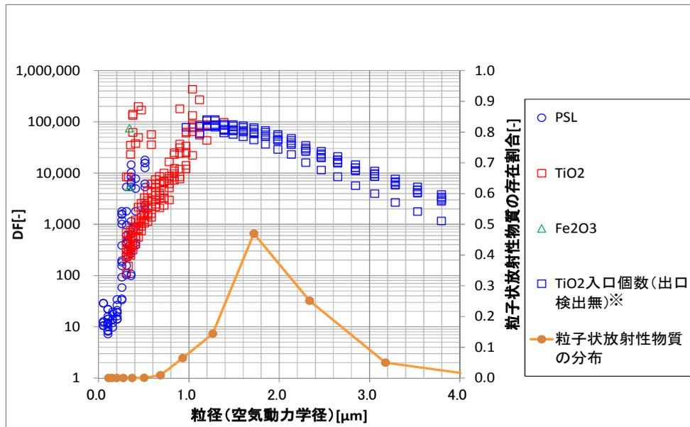
第 3.2.2.3-1 図 除去性能試験結果 (2Pd 相当流量)
