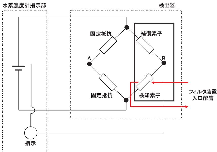
第 1-2 図 水素濃度計検出回路の概要図
