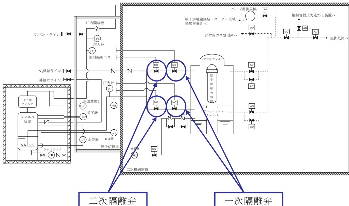
第 1.2.2-2 図 代替格納容器圧力逃がし装置系統概要図
