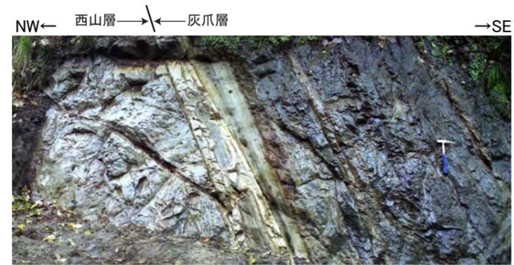
リニアメントの位置は、北西側の西山層塊状泥岩と南東側の灰爪層砂質泥岩との境界に対応しているが、同位置に断層は認められない。
