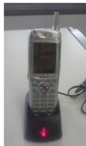
電力保安通信用電話設備 (PHS 端末)
