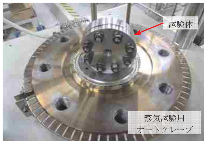
図4 蒸気暴露試験体設置状況
