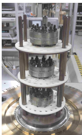
図3 蒸気暴露 試験片設置状況
