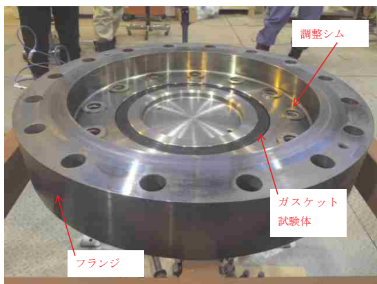
試験装置外観 (フランジ開放時)
