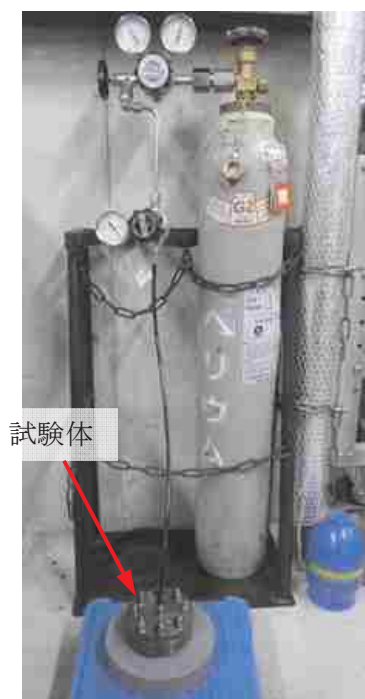
図5 He気密確認試験状況
