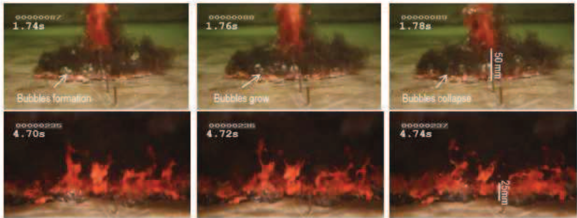
図付 4-8 PULiMS 実験 E4 ケースの溶融物拡がり挙動のスナップ写真 [21]
