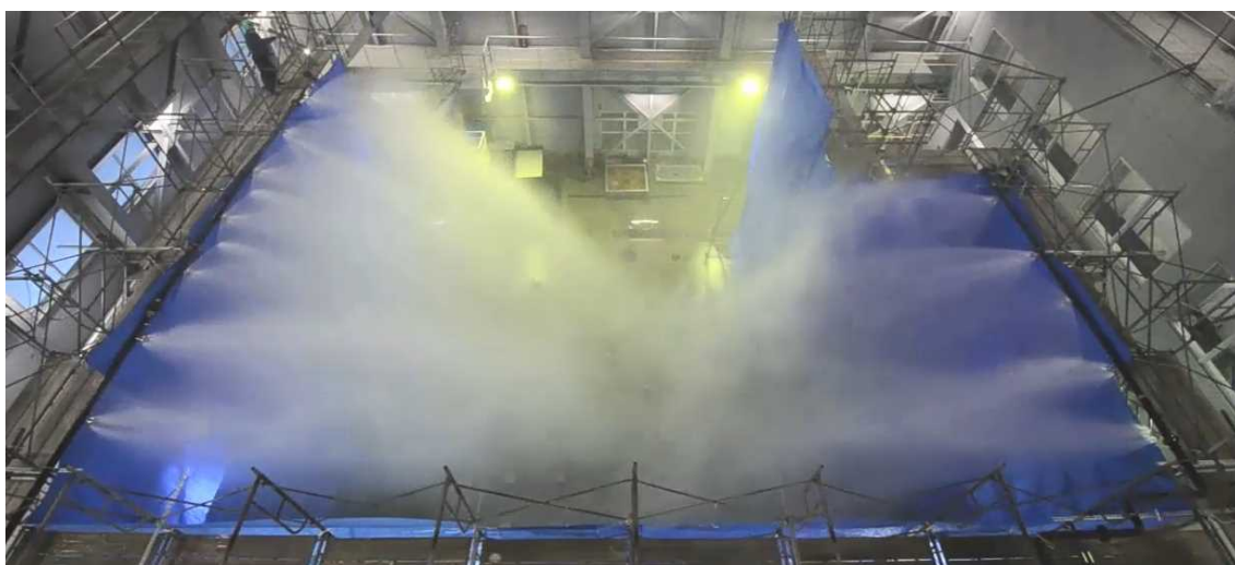
図9 スプレー状態の試験状況（スプレー量：132m 3 /h）
