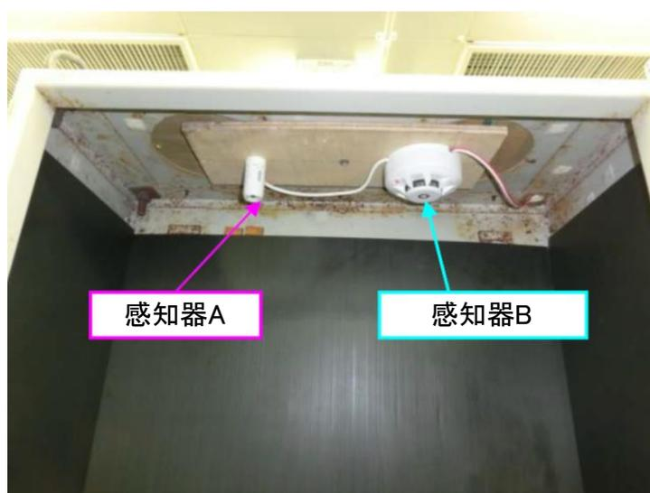
図 1 模擬盤天井面への感知器設置状況
