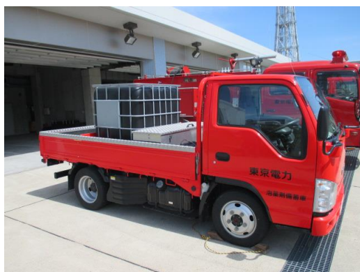
図2 泡消火薬剤備蓄車
