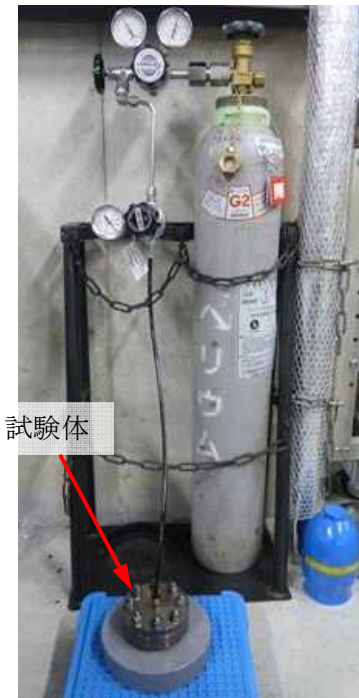
図5 He気密確認試験状況
