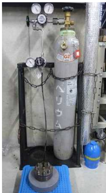
図 12 He 気密確認試験状況
