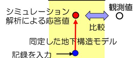
■ 同定した地下構造モデルによるシミュレーション解析結果は観測記録を良好に再現できていることを確認。
