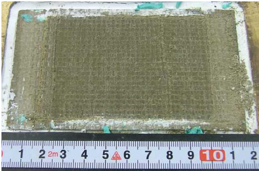
写真 3.3.4 一方向載荷試験後の供試体状況
