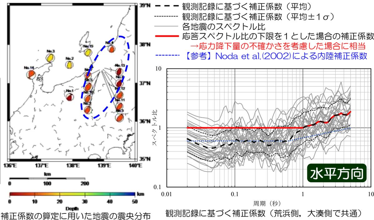
補正係数の算定に用いた地震の震央分布 観測記録に基づく補正係数 (荒浜側, 大湊側で共通)
