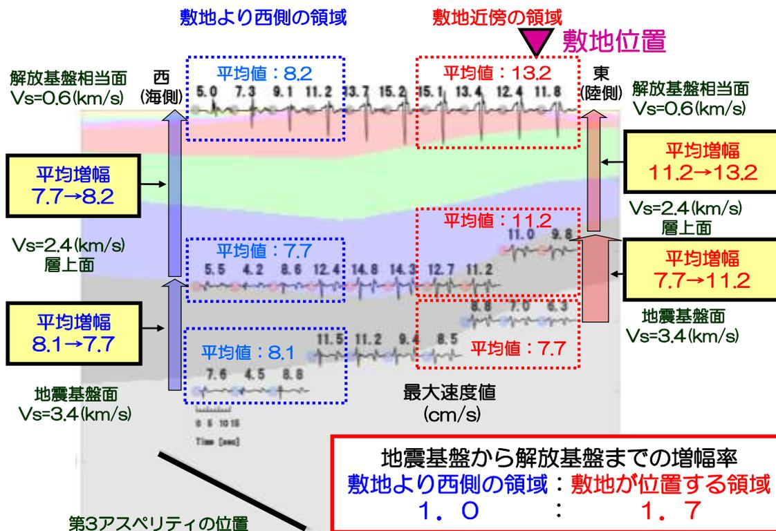
(1) 地震基盤から解放基盤までの増幅率
