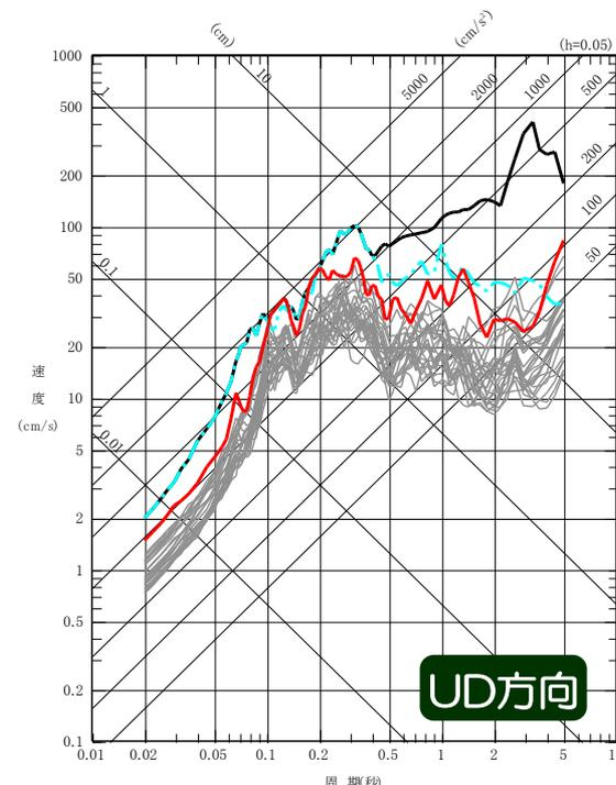
\*基準地震動Ssの包絡スペクトル：基準地震動Ssの各周期の最大値をとった応答スペクトル（以下同様）
