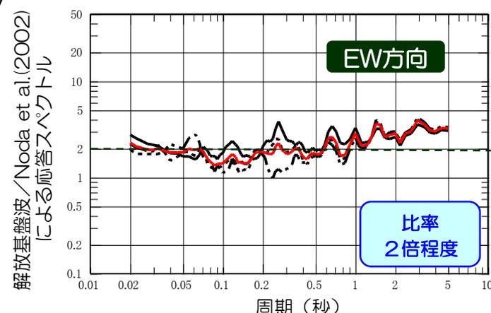
原子炉建屋基礎版上の観測記録から推定した解放基盤波とNoda et al.(2002)による応答スペクトルの比
