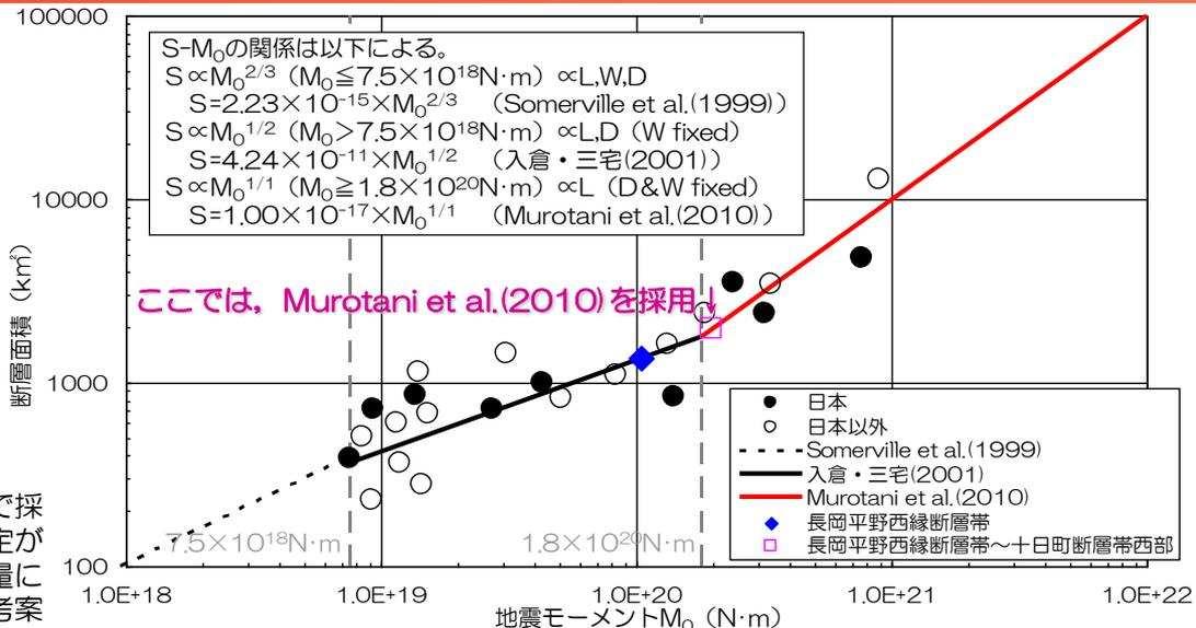
長岡平野西縁断層帯の評価で採用した方法1'ではモデル設定が困難なため、平均応力降下量に④'式を用いる方法1'を考案
