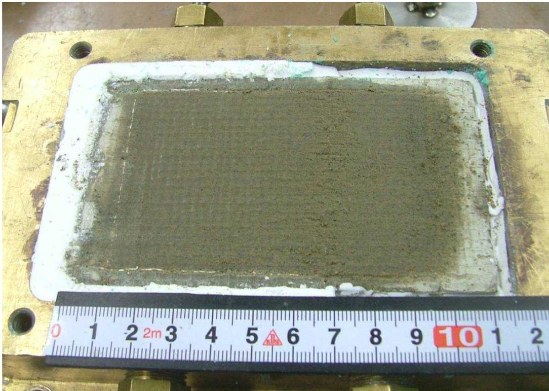
写真 3.3.14 繰返し荷重試験後の供試体状況 ケース 1-7 (西山モルタル表面)
