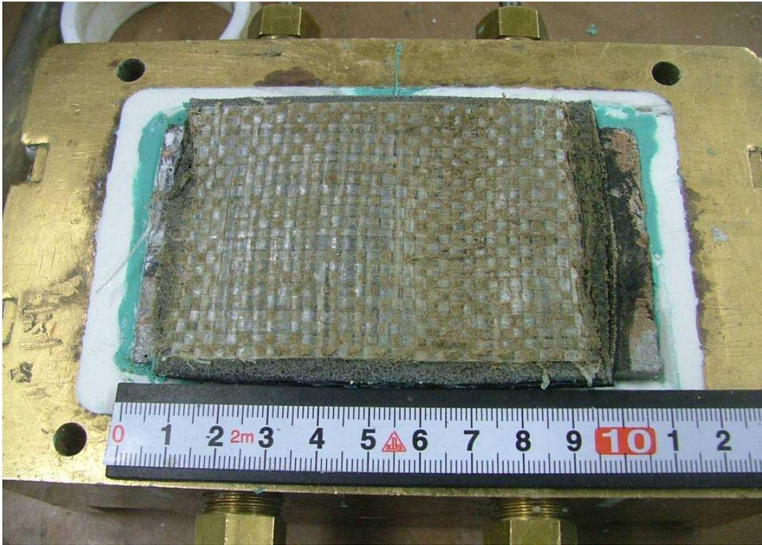
写真 3.3.13 繰返し荷重試験後の供試体状況 ケース 1-7 (保護層表面)
