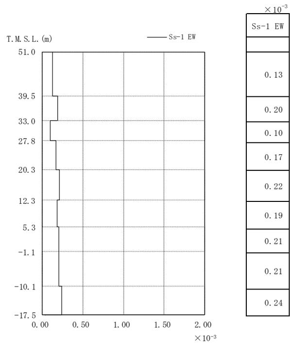
図 3.3-2 最大応答ひずみ EW 方向
