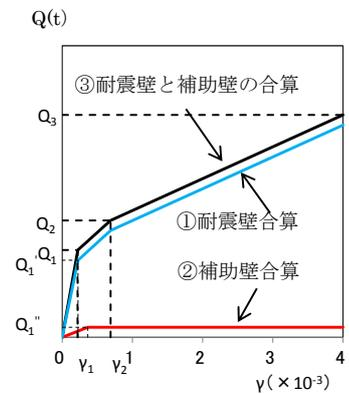
④ 地震応答解析モデルのためのスケルトンの設定 (Q-γ 曲線から τ-γ 曲線へ変換、SI 単位系に換算)
