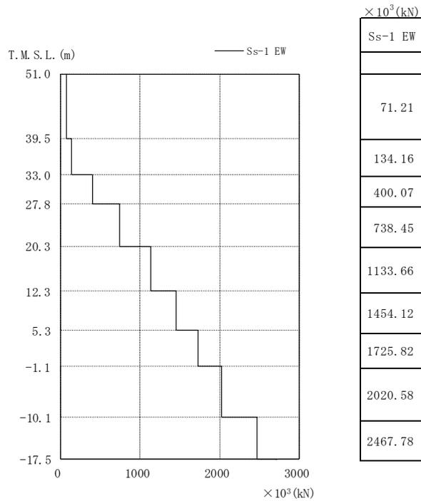
図 3.2-4 最大応答せん断力 EW 方向
