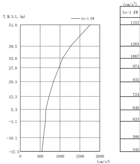
図 3.2-2 最大応答加速度 EW 方向
