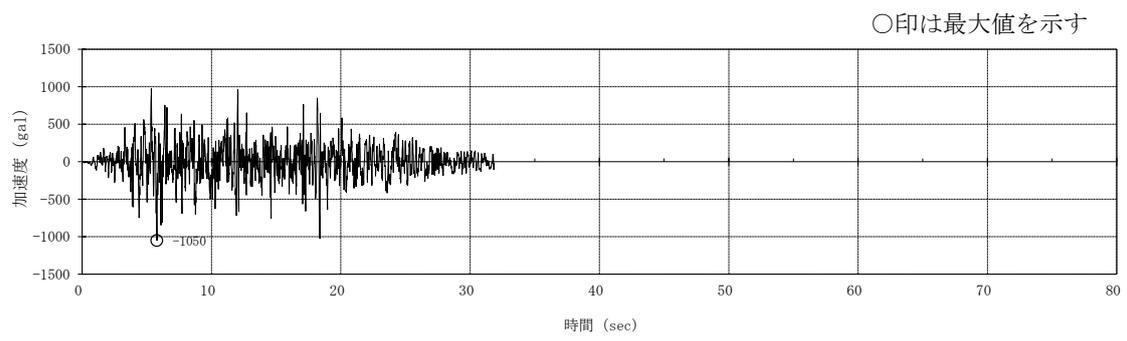
図 3.1-2 加速度時刻歴波形 (基準地震動 Ss-1H)
