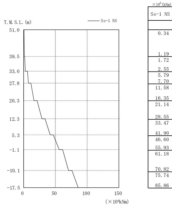
図 3.2-5 最大応答曲げモーメント NS 方向
