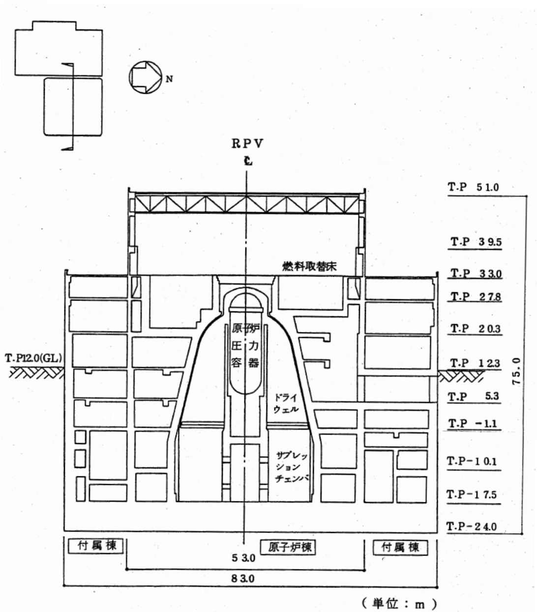
図 2.1-3 建屋断面図 (EW 方向)
