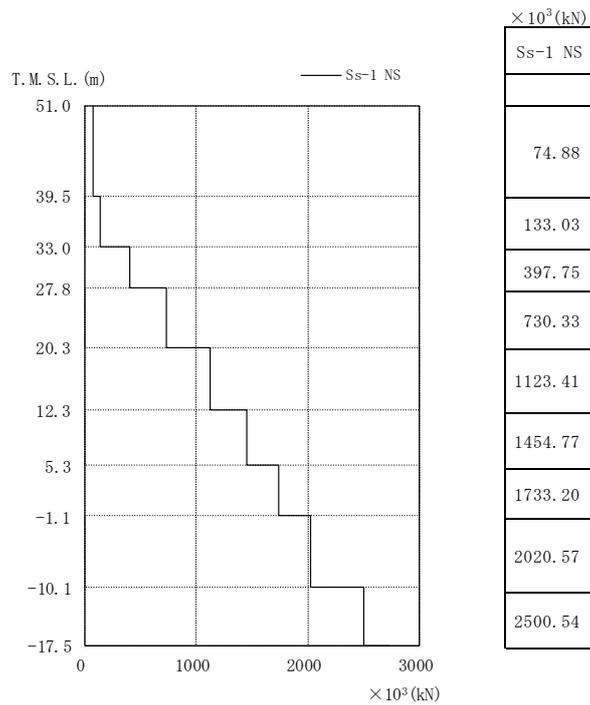
図 3.2-3 最大応答せん断力 NS 方向
