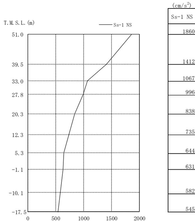
図 3.2-1 最大応答加速度 NS 方向
