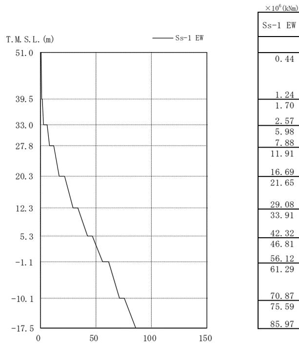
図 3.2-6 最大応答曲げモーメント EW 方向
