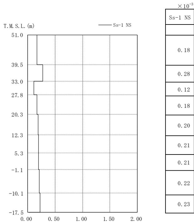
図 3.3-1 最大応答ひずみ NS 方向
