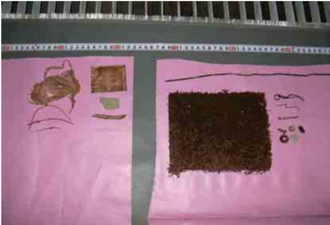
柏崎刈羽原子力発電所 7号機 S / C内異物回収結果
