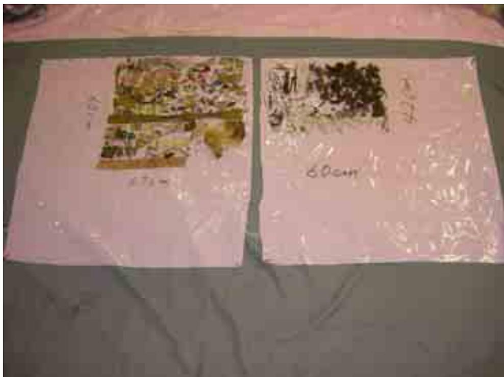
柏崎刈羽原子力発電所 1号機 S / C内異物回収結果
