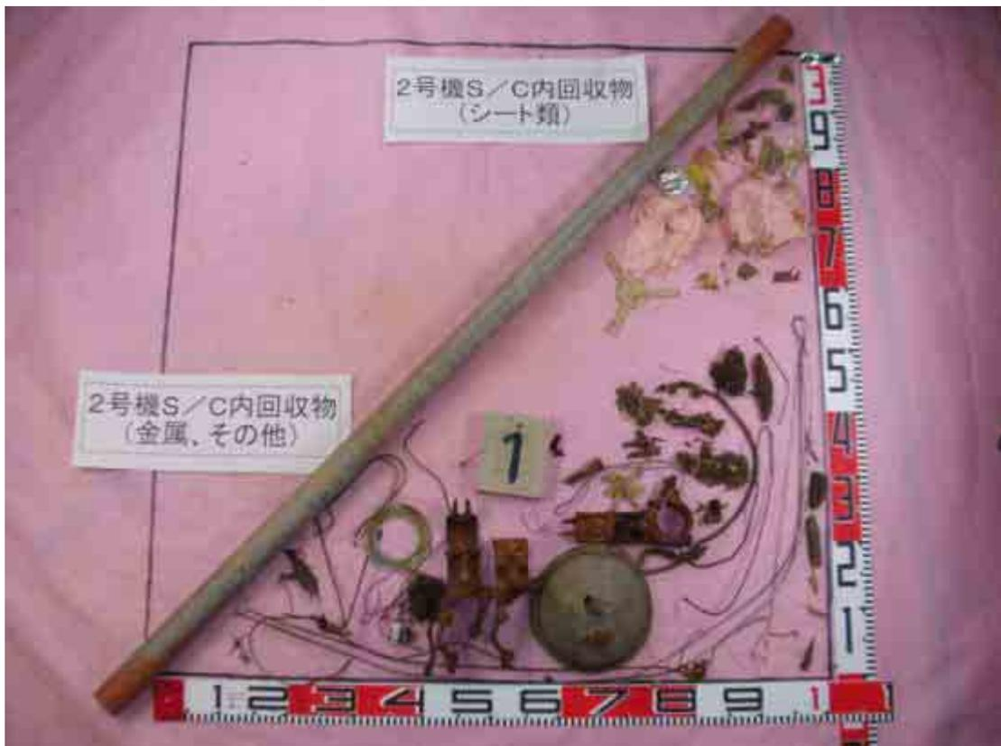
福島第一原子力発電所 4号機 S/C 内異物回収結果
