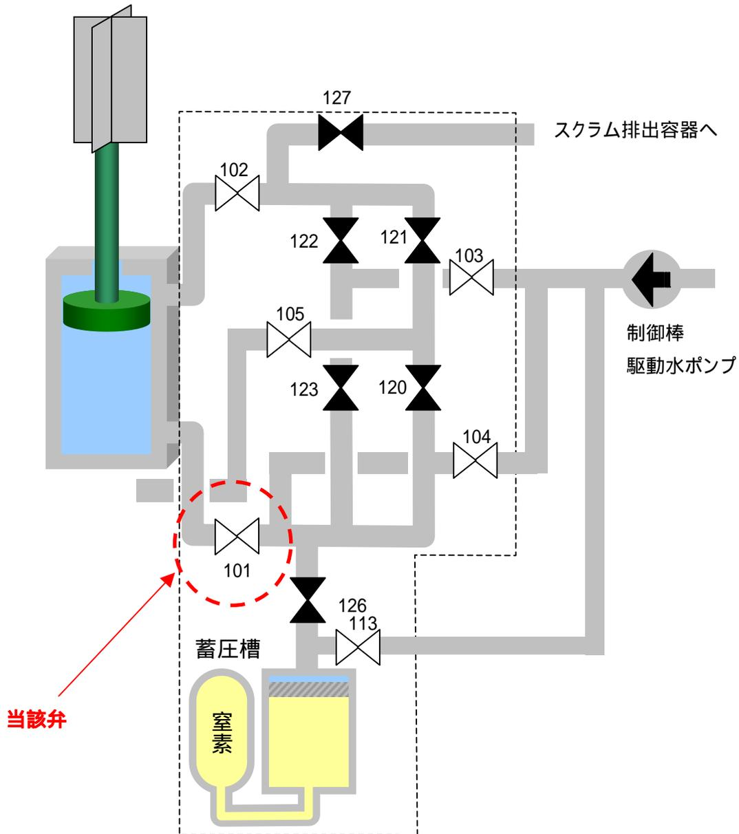
水圧制御ユニット(制御棒を炉心内に挿入したり引き抜きしたりするため、制御棒駆動機構に駆動水を送る装置。また、非常時に制御棒を高圧水で緊急挿入(スクラム)させるための蓄圧槽がついている)
