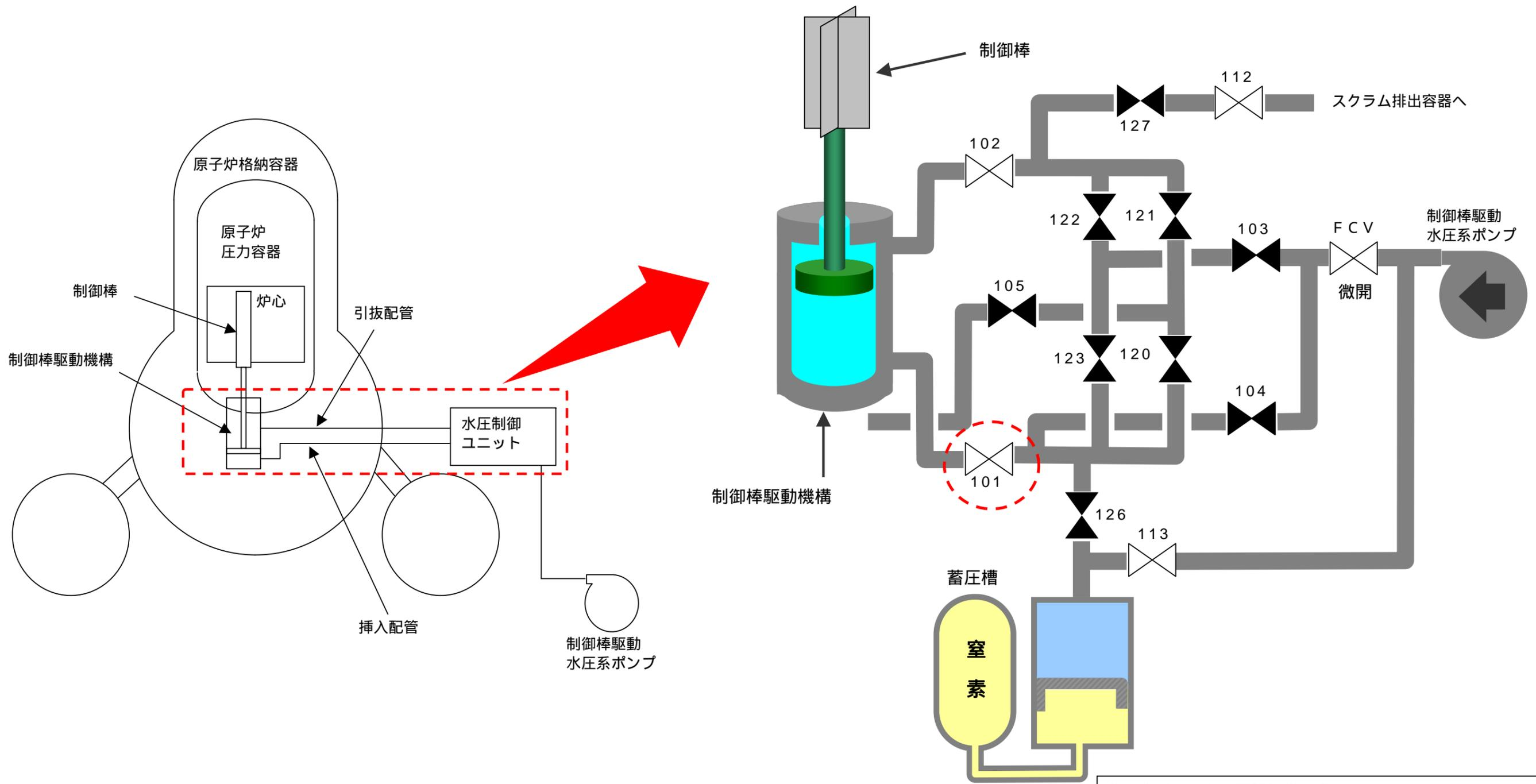
復旧作業時の弁の開閉状態を明示
