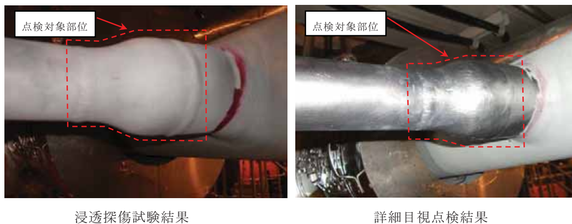
図-2 詳細目視点検及び浸透探傷試験結果
