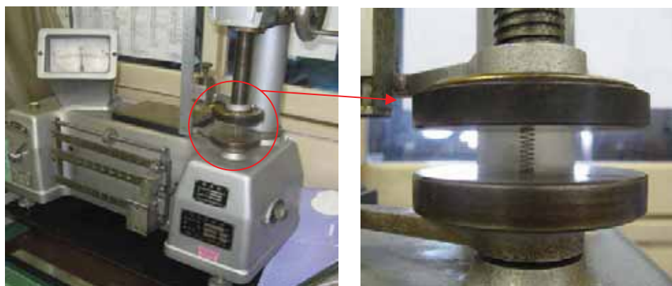
図-5 バネ力測定試験状況
