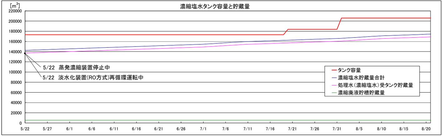
注記 ・処理装置の処理量は、900m<sup>3</sup>/dと想定(T/B滞留水水位等の状況により処理量を変更)
