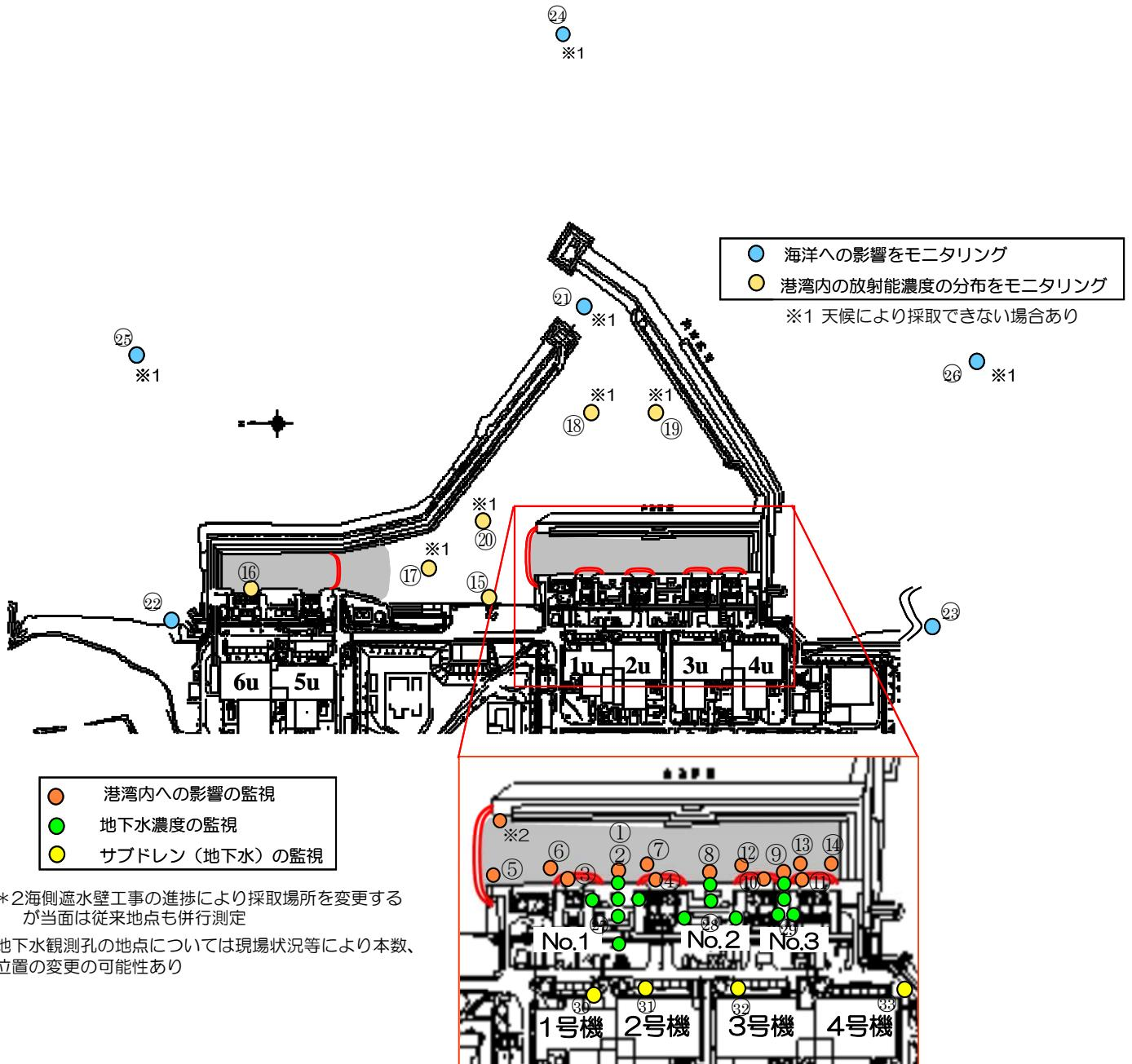
図1 地下水及び港湾内の海水モニタリング地点
