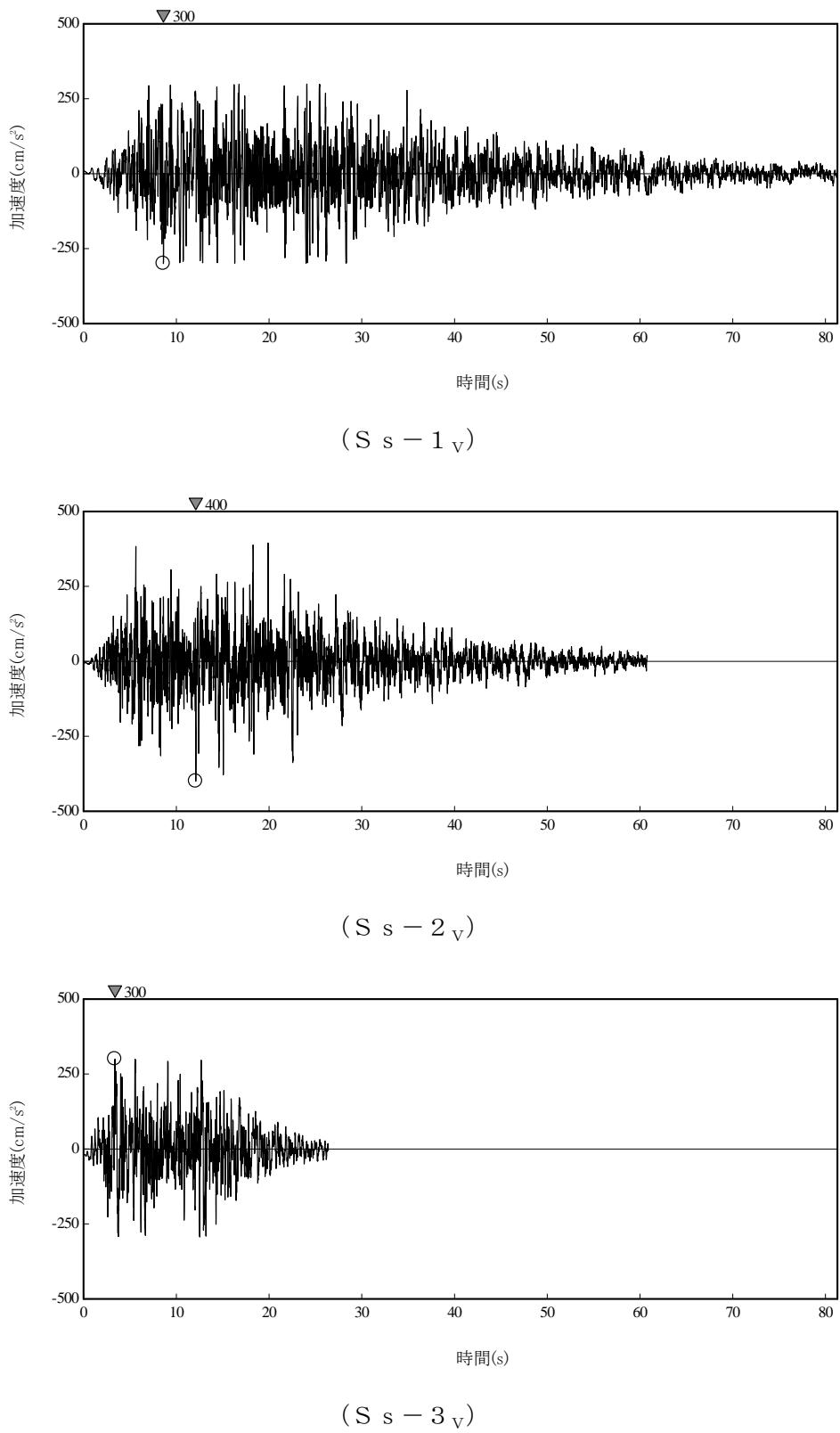
図-11 解放基盤表面位置における地震動の加速度波形（鉛直方向）
