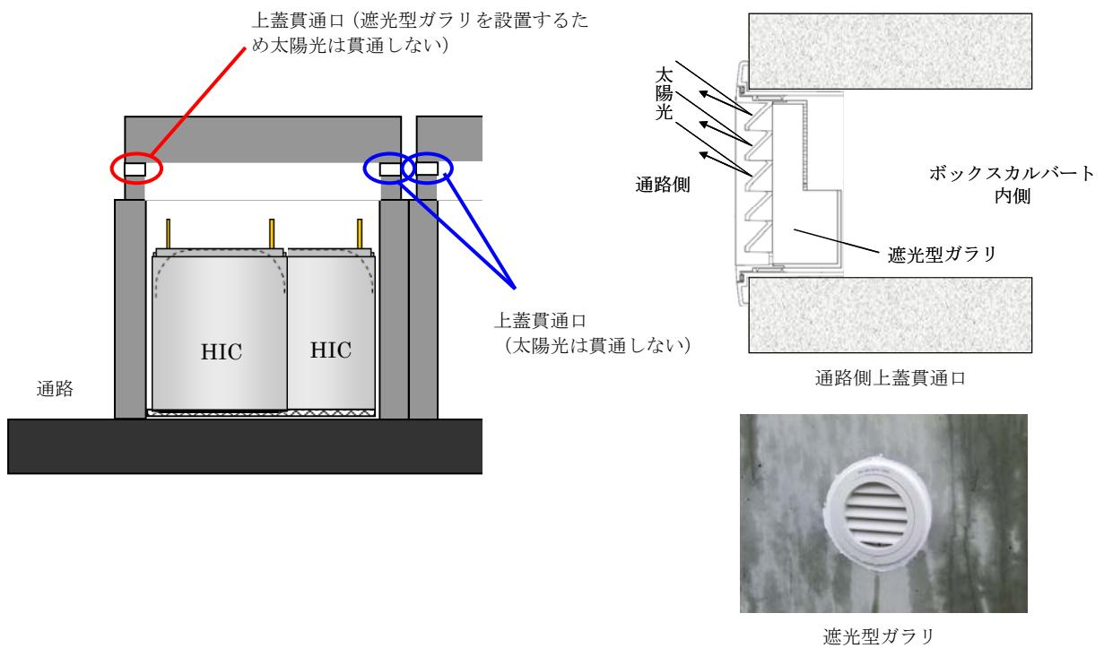
図3 一時保管施設（第二施設）ボックスカルバート内HIC収容イメージ
