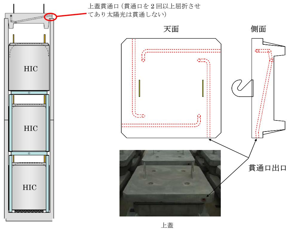
図4 一時保管施設（第三施設）ボックスカルバート内HIC収容イメージ
