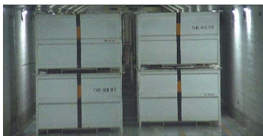
角型容器 (高線量瓦礫類)
