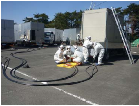
福島第二における電源車負荷研修 (左：ケーブル絶縁抵抗測定および負荷車との接続 右：電源車並列運転)
