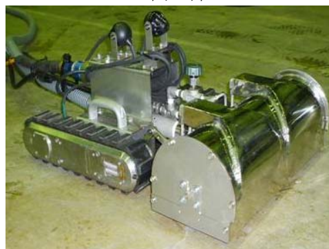
ブラシヘッドを装着した 遠隔除染装置（ラクーン）
