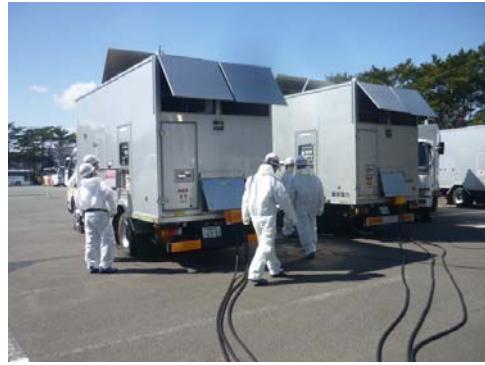
福島第二における電源車負荷研修 (左：ケーブル絶縁抵抗測定および負荷車との接続 右：電源車並列運転)
