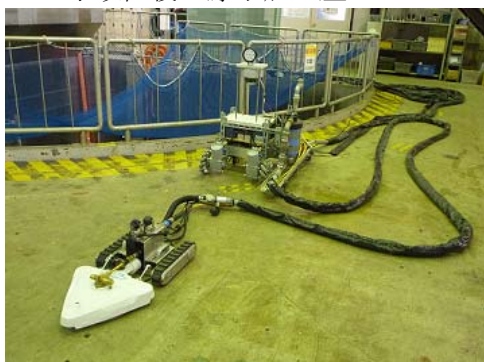
ジェットヘッドを装着した 遠隔除染装置（ラクーン）
