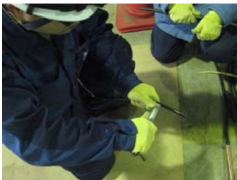
柏崎刈羽における低圧、高圧ケーブル末端処理訓練 (左：低圧ケーブルのシース剥がし、右：高圧ケーブルのシース剥がし)
