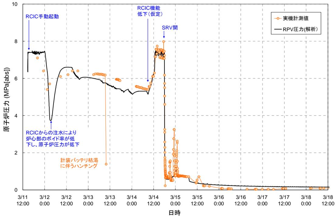
図5 2号機 原子炉圧力変化 (今回解析結果)
