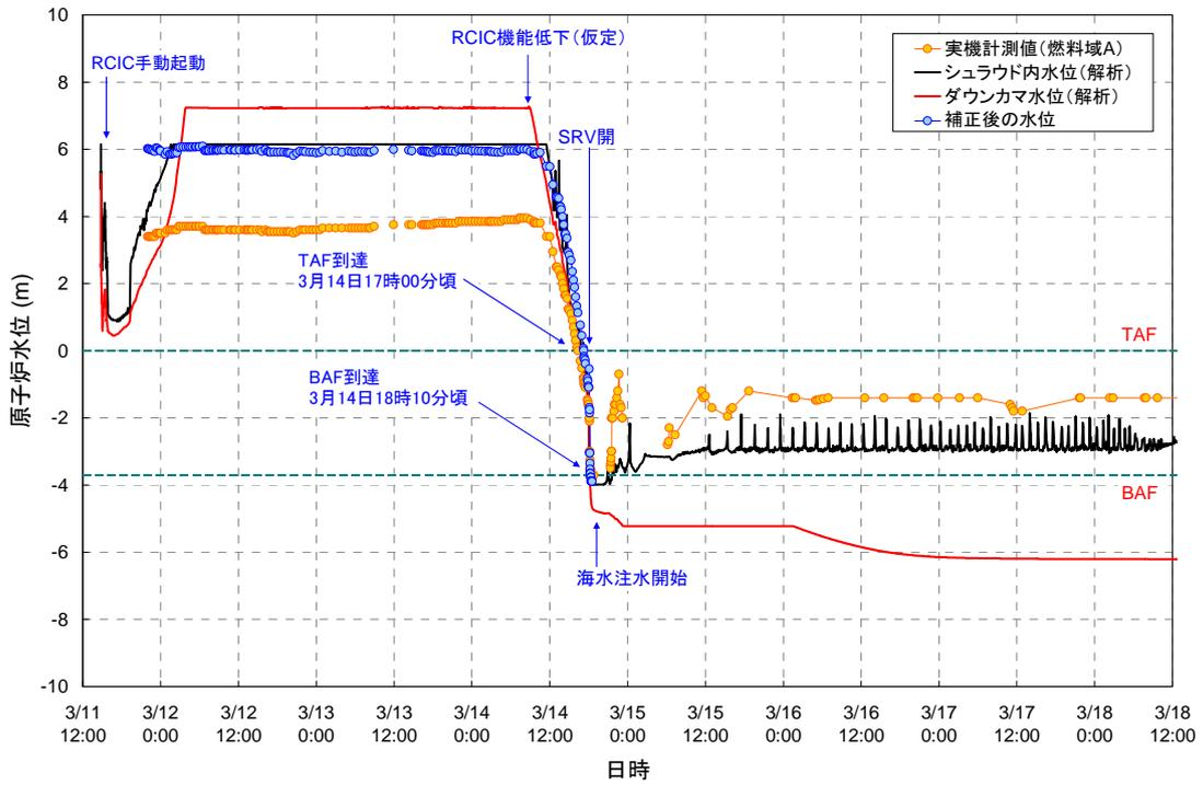
図3 2号機 原子炉水位の変化 (今回解析結果)
