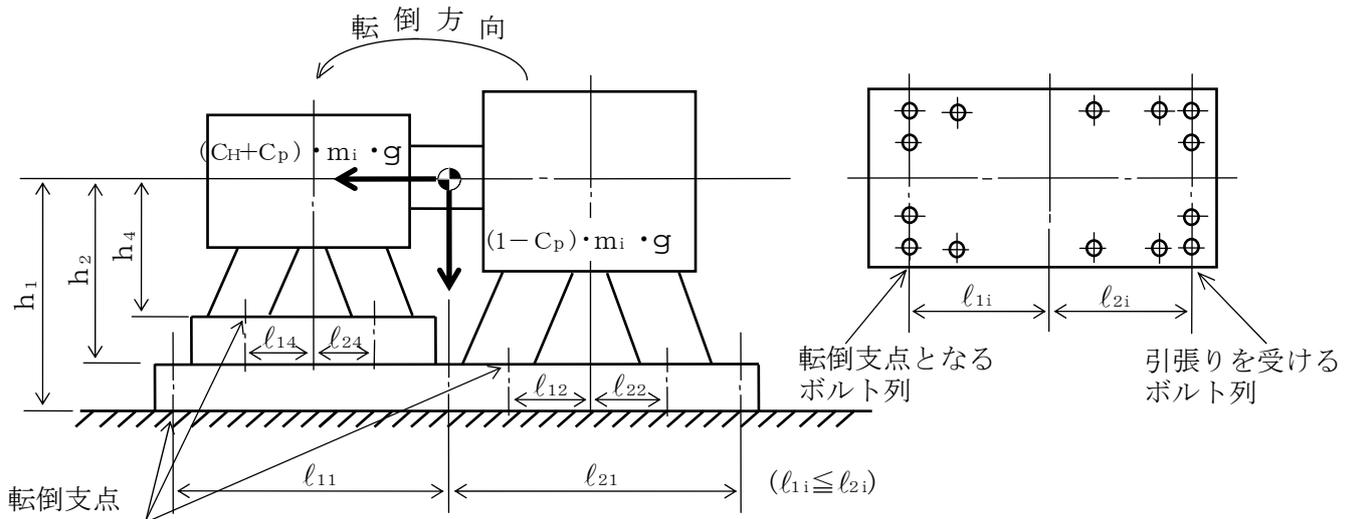
図 2-2 計算モデル（軸方向転倒）
