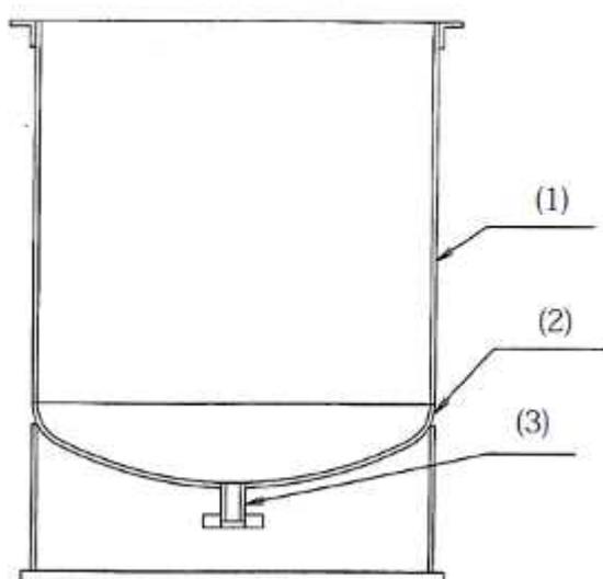
図－ 1－ 1 処理水受入タンク 概要図
