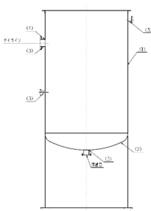
図－ 1－ 2 共沈タンク, 供給タンク 概要図
