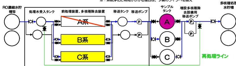
【STEP3：再処理ラインによるサンプルタンクの浄化
