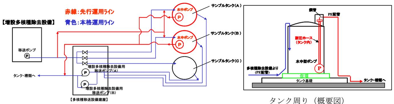
図1 多核種移送設備における本格運用および先行運用ライン概要図
