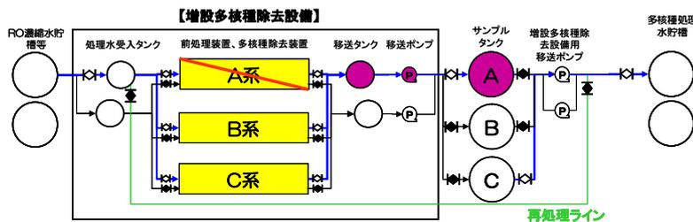
【STEP1：A系隔離、B/C系による系統洗浄】
