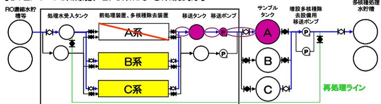
【STEP2：系統浄化確認後※にサンプルタンクA隔離&Bへ切替え】
