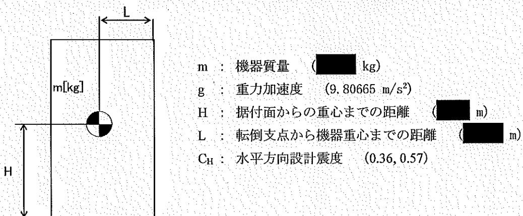
$$\text{地震による転倒モーメント} : M_1 [\text{N} \cdot \text{m}] = m \times g \times C_H \times H$$
