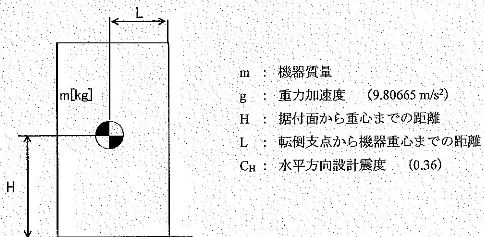
$$\text{地震による転倒モーメント : } M_1 [\text{N} \cdot \text{m}] = m \times g \times C_H \times H$$
