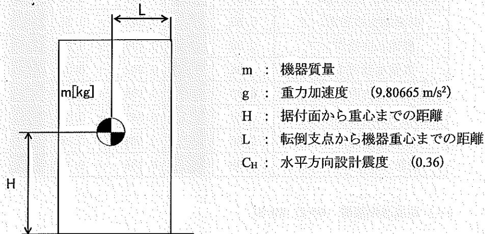
$$\text{地震による転倒モーメント} : M_1 [\text{N} \cdot \text{m}] = m \times g \times C_H \times H$$
