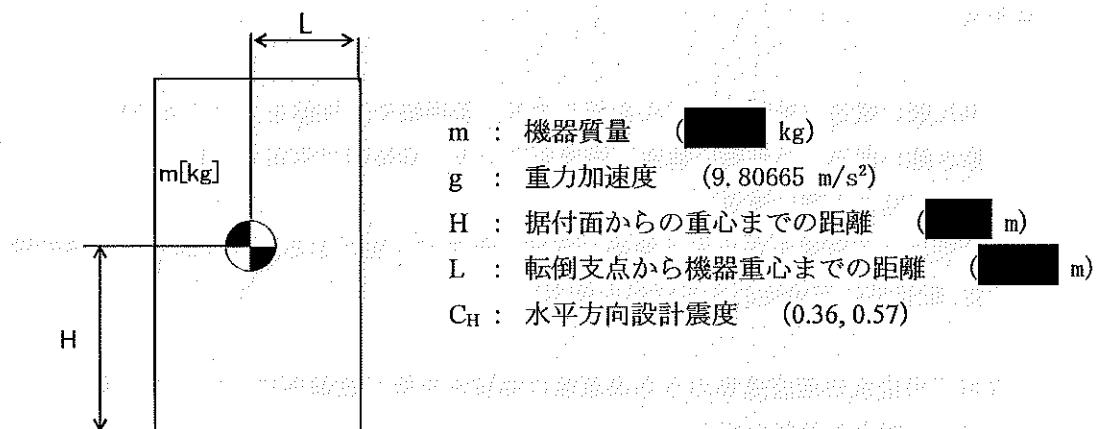
$$\text{地震による転倒モーメント : } M_1 [\text{N}\cdot\text{m}] = m \times g \times C_H \times H$$
