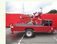
大容量放水設備を配備、重大事故に伴い放射性物質が放出された場合、湿分による沈着を図る
