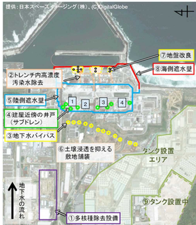
汚染水対策の主な作業項目
