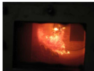
焼却炉内の燃焼状況
