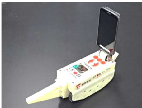
原子炉格納容器の開口部調査用ロボット
