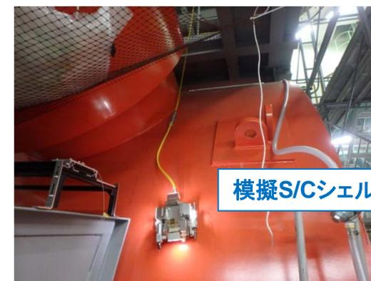
S/C下部外面調査装置工場試験
