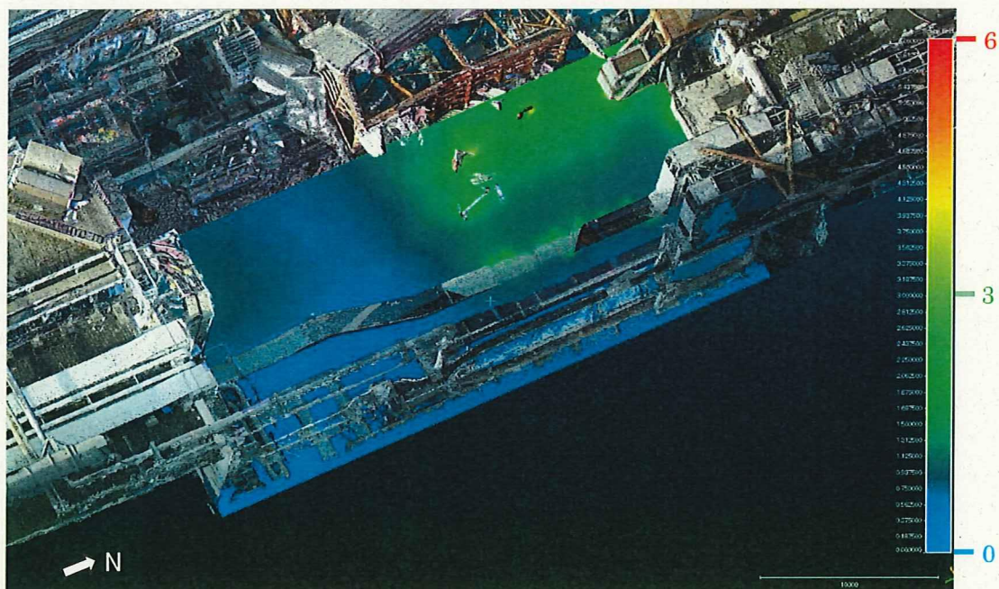
図7-7 1、2号機コントロール建屋 地面から1m高さの線量率分布（俯瞰） [mSv/h]
