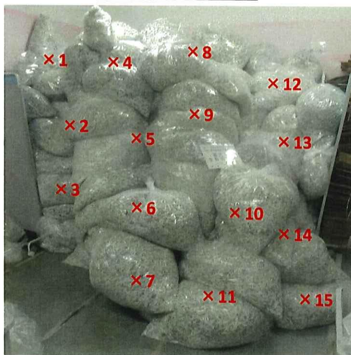
シュレッダー屑 表面線量率測定結果 ( \mu\text{Sv/h} )
