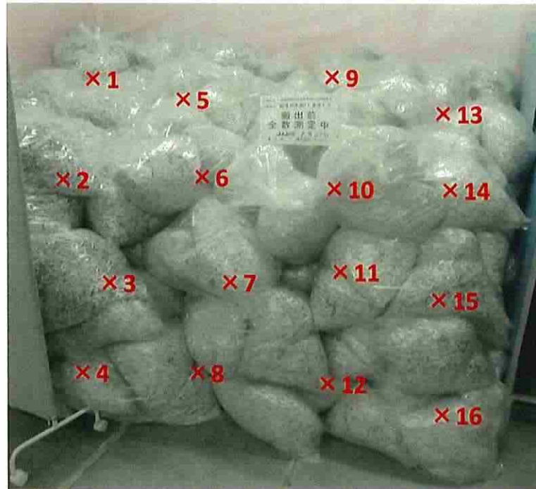
シュレッター屑 表面線量率測定結果 ( \mu\text{Sv/h} )
