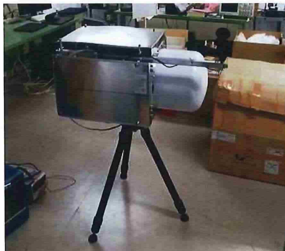
図2： 三脚に固定した ETCC の写真（ において別日に撮影）
