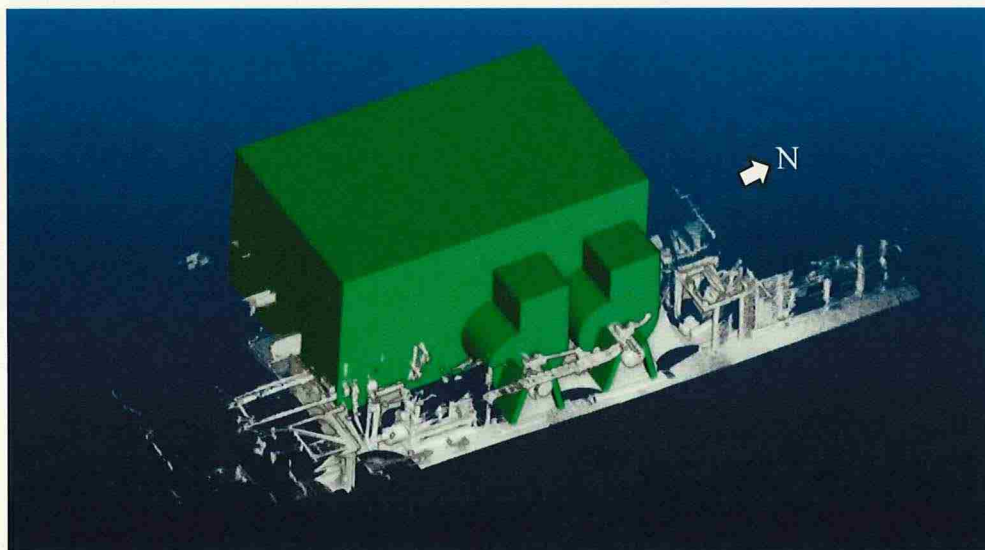
図 35 南側エリアにおける排風機遮蔽モデル（俯瞰）
