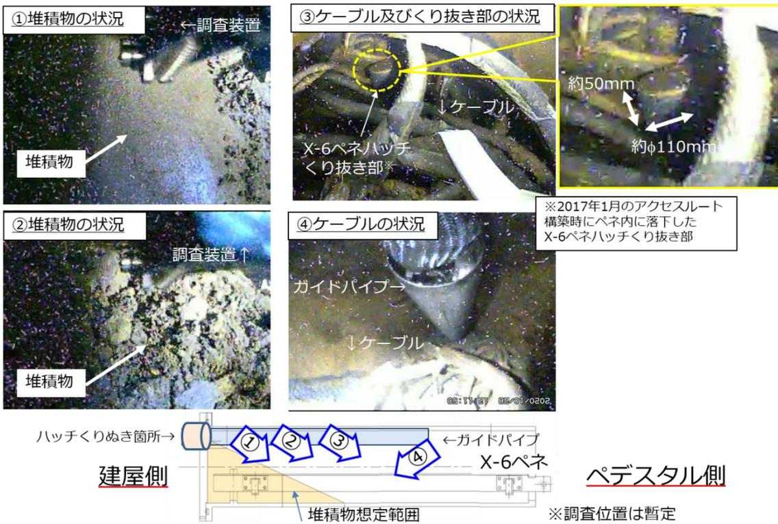
図 3-22 X-6 ペネ内堆積物の接触調査結果②<sup>[3-13]</sup>
