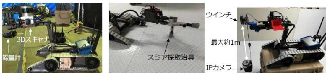
図 2- 27 遠隔操作ロボット[2-19]
