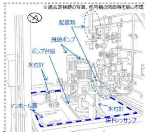
2号機T/B床ドレンサンプの調査状況
