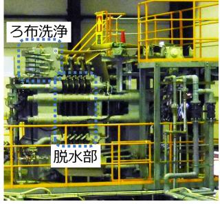
安定化(脱水)処理装置(フィルタープレス機)
