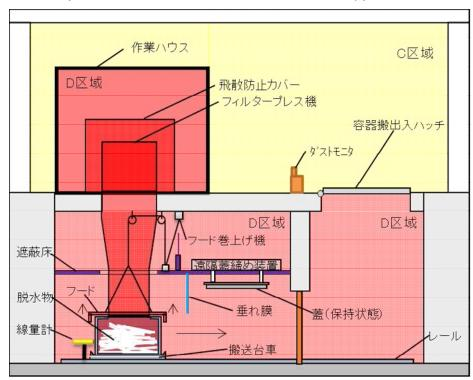
左図:フィルタープレス機周りの想定汚染レベル (脱水物容器充填の終了時イメージ)
