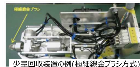
少量回収装置の例(極細線金ブラシ方式)
