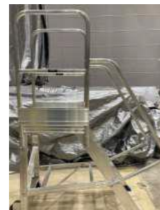
①作業階段 (同様の型を撮影) 上部からフックを引っ掛けて、集積 作業開始前に紐で吊り上げる予定
