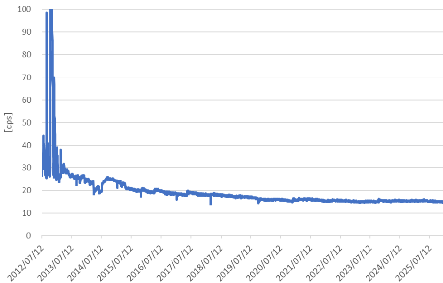
1号機PCVガス管理設備ダストモニタ (長期)
