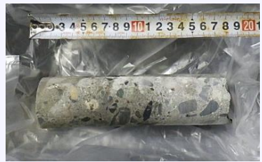
コンクリートコアの採取・分析
