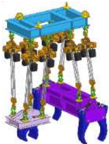
天井クレーントリオリ把持装置
