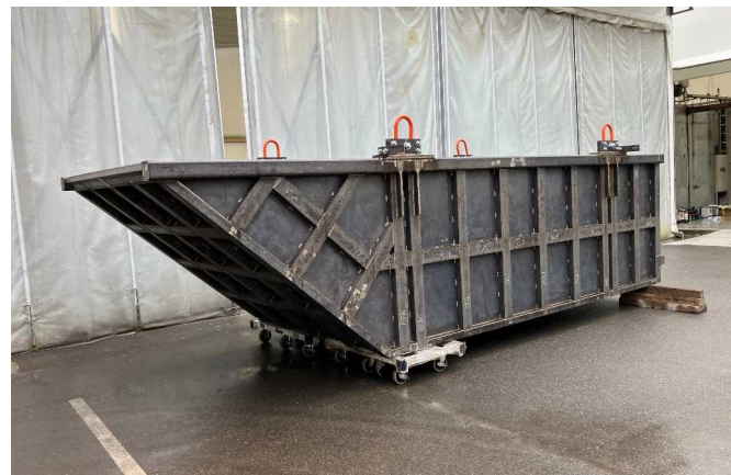
構内運搬容器（ベッセル等）
