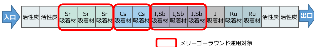
図 II-2 吸着塔構成の例 (2018 年 9 月時点での例)
