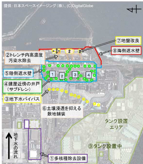
汚染水対策の概要図 (敷地平面図)
