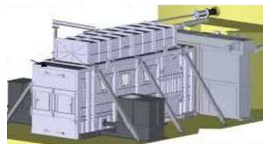
隔離部屋の設置 試験的取り出し装置設置前まで使用
