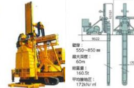
地盤改良 (セメント改良土等)
